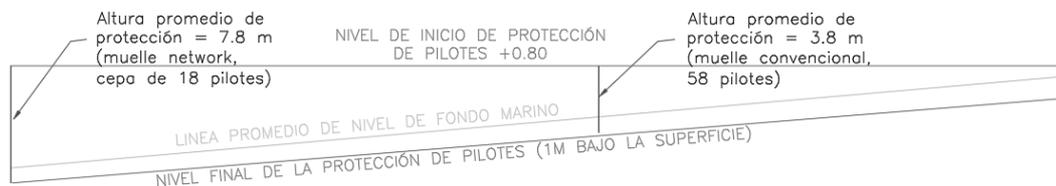
Figura 5.1: Esquema de las alturas promedio para la protección de los pilotes en los sistemas tradicional y no convencional.
