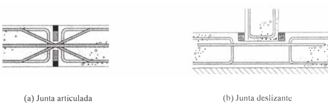
**Figura 1.4.** Junta con un propósito en especial
