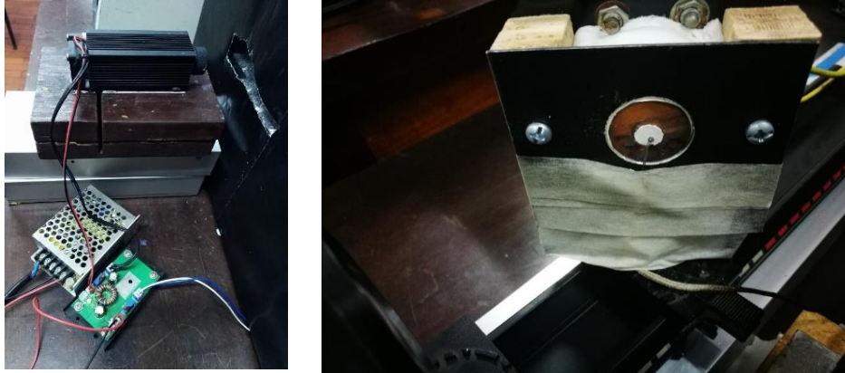
Figura 4. 26 IZQUIERDA: Laser de 980nm para generar pulsos, DERECHA: Soporte de Pastilla con Sistema de Calentamiento
