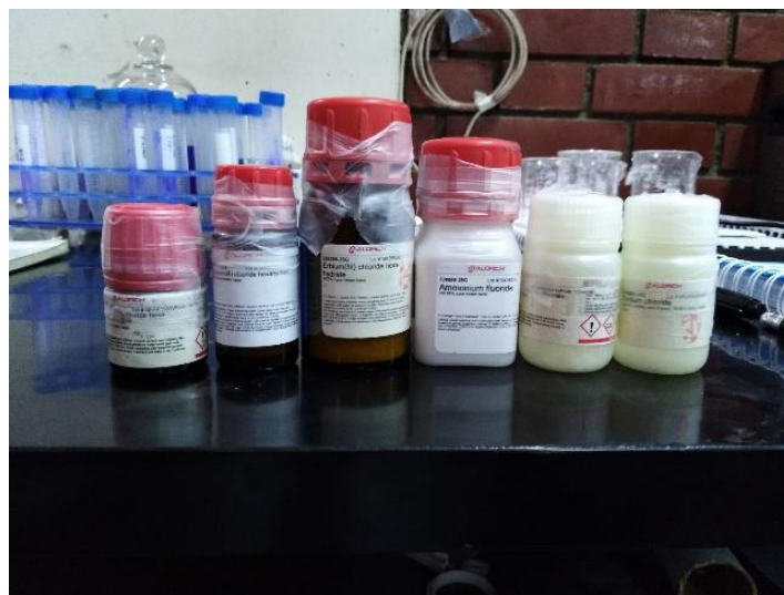
Figura 4. 3 Materiales para la síntesis (derecha a izquierda) (a) \text{NaCl} , (b) \text{YCl}_3 \cdot 6\text{H}_2\text{O} , (c) \text{NH}_4\text{F} , (d) \text{ErCl}_3 \cdot 6\text{H}_2\text{O} , (e) \text{YbCl}_3 \cdot 6\text{H}_2\text{O} .
