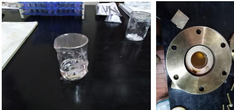
Figura 4. 6 IZQUIERDA: Vaso número 1, listo para la síntesis en la mufla. DERECHA: Teflon en la autoclave, listo para meterlo en la Mufla.
