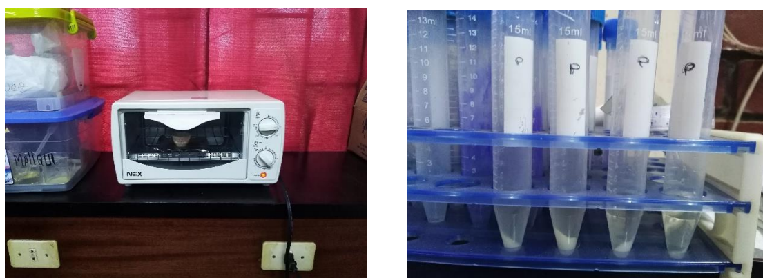
Figura 4. 8 IZQUIERDA: Crisol en el horno microondas, proceso de secado. DERECHA: Presencia de nuestras partículas en la base de los tubos de centrifugado.
