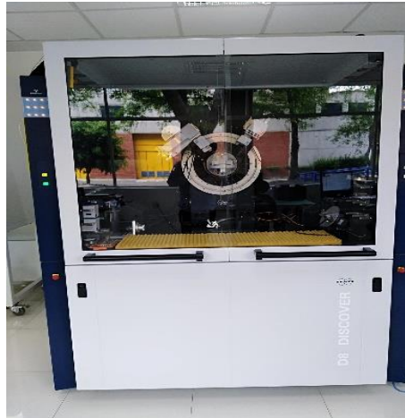
Figura 4. 19 DRX Marca Bruker D8 Discover
