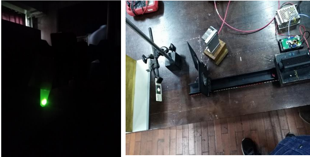
Figura 4. 11 IZQUIERDA: Muestra de \text{NaYF}_4:\text{Er},\text{Yb} con tratamiento termico de 500 °C por 5 horas excitada con un láser de 980 nm a 0.8 watt de potencia. DERECHA: Disposición del láser para excitar las muestras de \text{NaYF}_4:\text{Er},\text{Yb}
