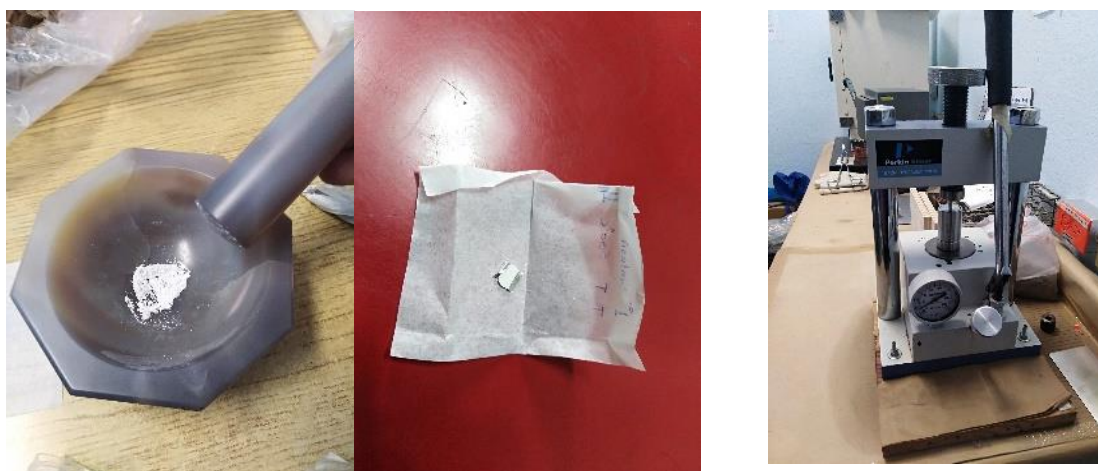
Figura 4. 12 IZQUIERDA: Mortero y Pastilla de \text{NaYF}_4 : Er, Yb. DERECHA: La prensa hidráulica Perkin Elmer de 15 toneladas
