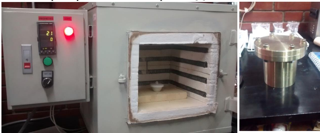
Figura 4.1 IZQUIERDA: Horno del Laboratorio de Óptica Fotónica. DERECHA: Autoclave Utilizado para la síntesis del nanomaterial.
