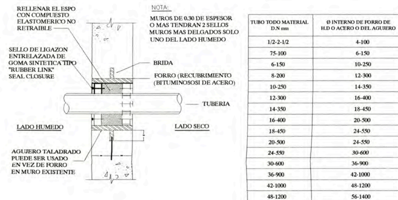
PENETRON DE TUBO - TIPO 3 NO SUMERGIDO DE TODO TAMAÑO SIN ESCALA
