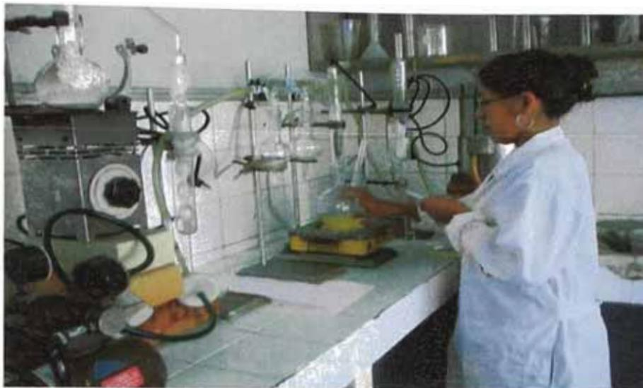
Foto N°20.- Equipo de Destilación de cianuros; Laboratorio de Espectrometría – UNI – FIGMM
