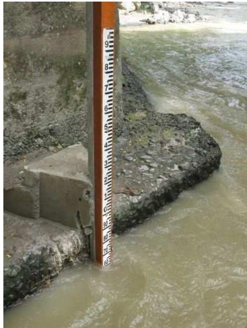
Figura 2.5: Limnómetro
