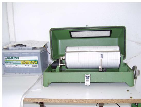
Figura 2.6: Limnógrafo
