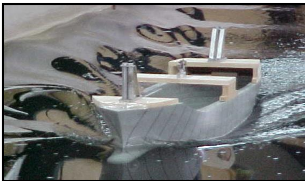
Figura 15. Ensayo de canal (Universidad Austral de Chile, 2003)
