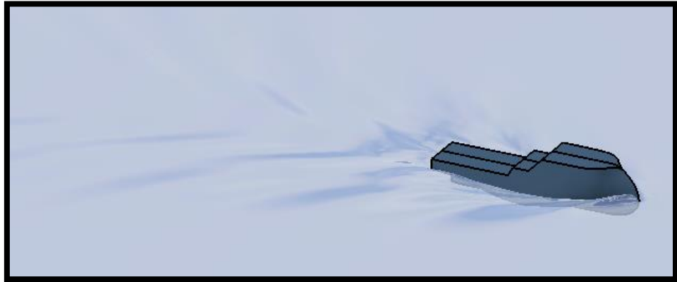
Figura 29. Representación realista, tren de olas X-Bow 15 nudos
