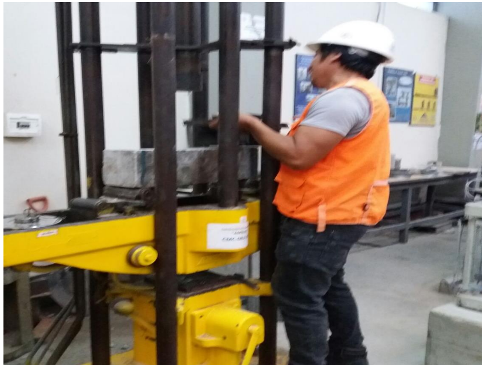
Figura 16: Rotura de Viga de Concreto Fuente: Elaboración propia
