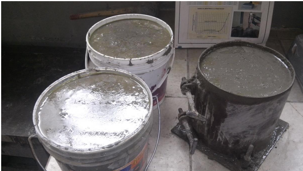
Figura 10: Concreto vertido sobre moldes para Tiempo de Fraguado Fuente: Elaboración propia
