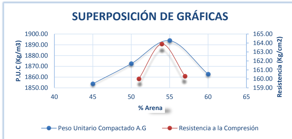
Figura 4. 6: Superposición de gráficos del P.U.C. y la resistencia a los 7 días, a/c=0.70 Fuente: Elaboración propia
