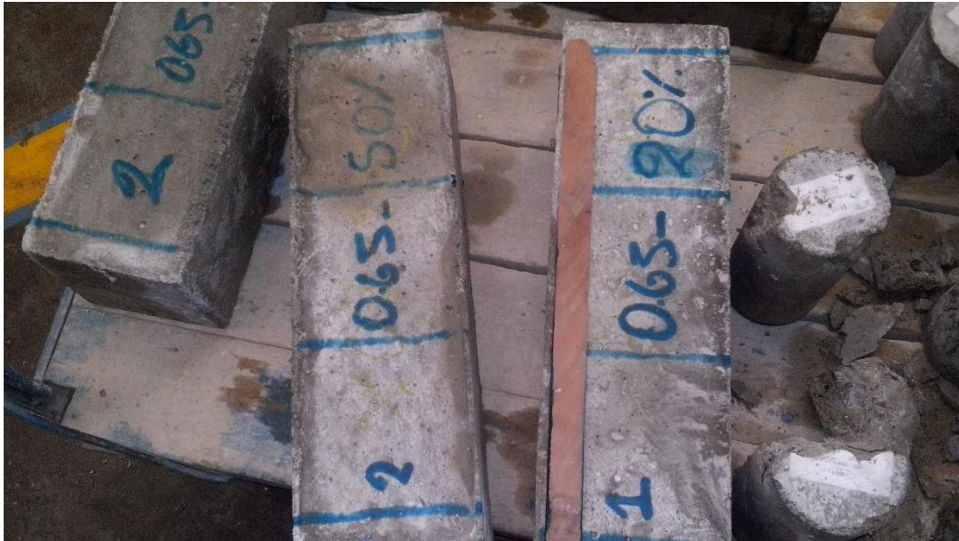
Figura 15: Marcado de vigas de concreto a un tercio para ser ensayadas Fuente: Elaboración propia
