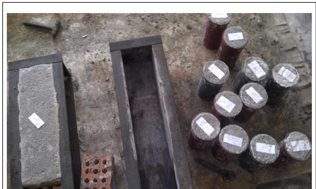
Figura 6: Desmoldado de Vigas y probetas de Concreto Fuente: Elaboración propia
