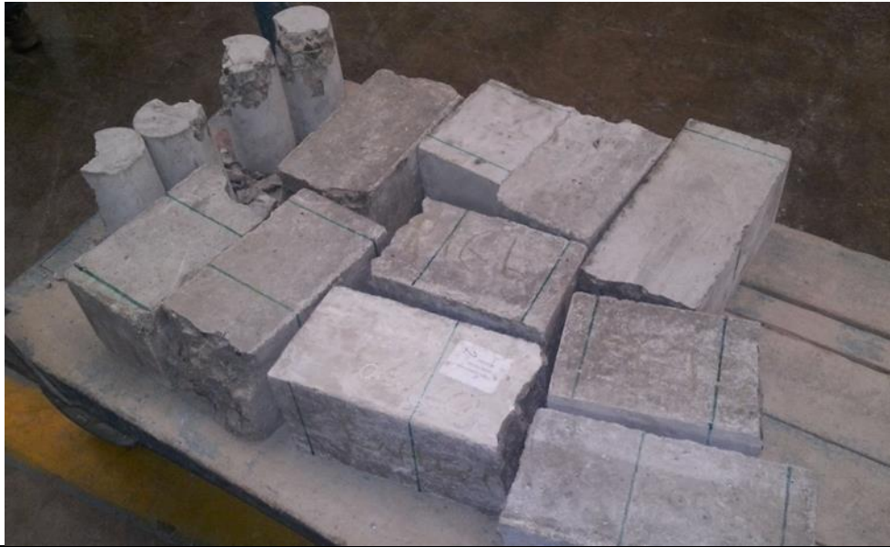
Figura 17: Probetas y Vigas Ensayadas Fuente: Elaboración propia
