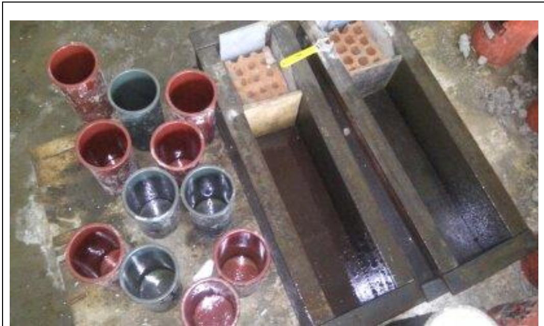
Figura 5: Moldes de Probetas y de Vigas para el concreto. Fuente: Elaboración propia
