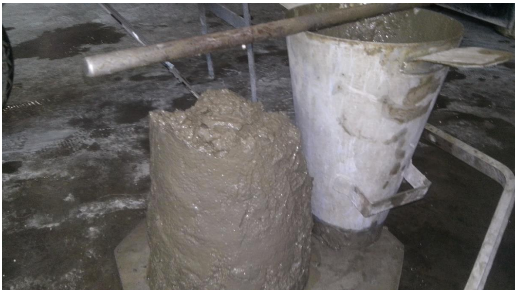
Figura 8: Ensayo de Consistencia del Concreto Fuente: Elaboración propia
