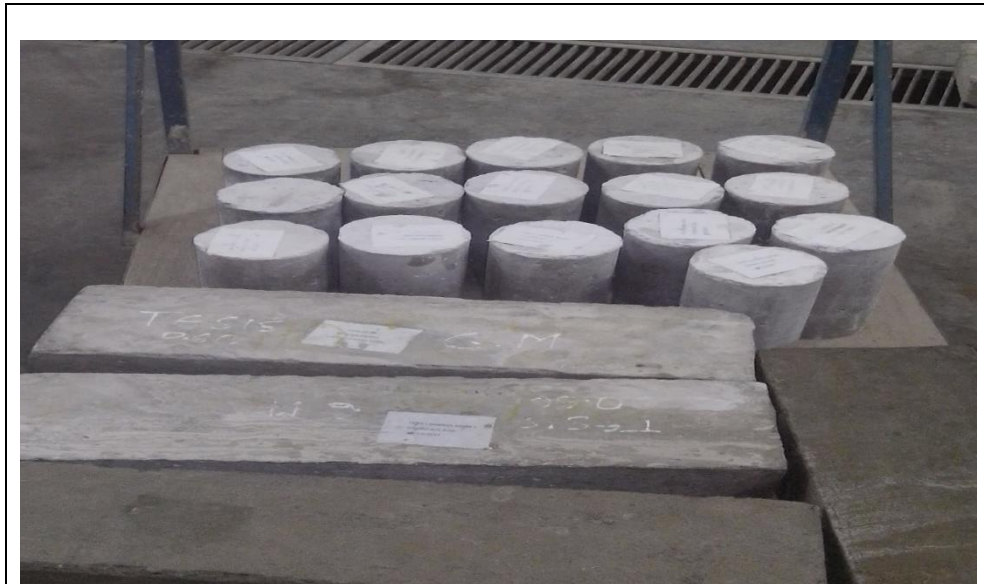
Figura 13: Probetas y Vigas Retiradas del Curado Fuente: Elaboración propia
