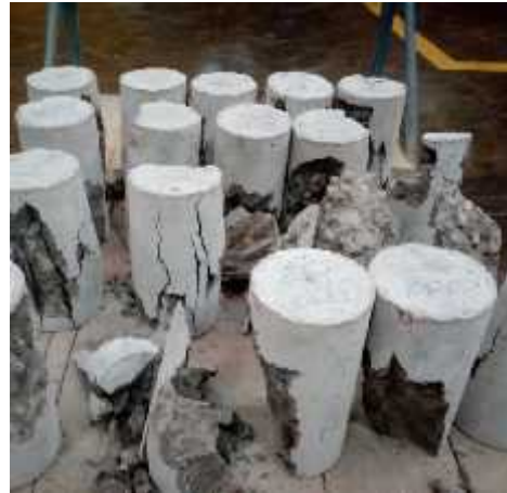
FIGURA F.7 Probetas después de la prueba de compresión axial.
