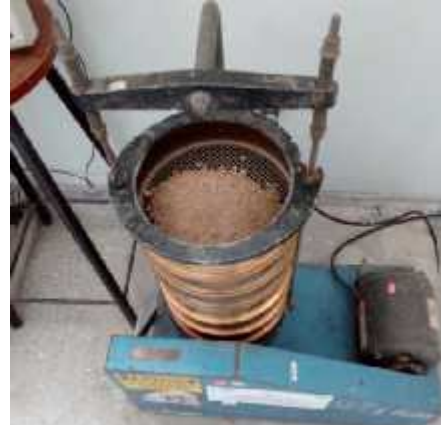
FIGURA F.3 Tamizado del agregado fino para el ensayo de granulometría.
