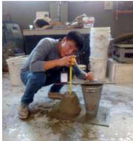
FIGURA F.7 Prueba de asentamiento del concreto en estado fresco.
