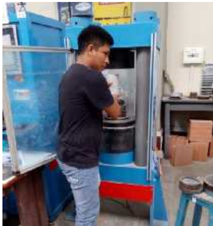
FIGURA F.7 Colocación de probeta de concreto en la máquina de compresión axial.
