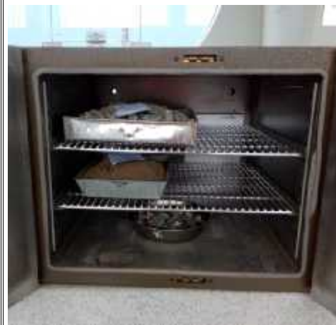
FIGURA F.2 Secado al horno (105 °C) de los agregados después de ser remojados en agua.
