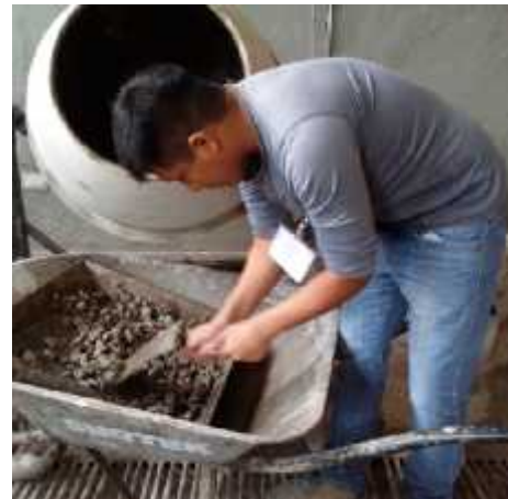
FIGURA F.3 Tamizado del concreto para obtener mortero que utilizaremos en la prueba de tiempo de fragua.
