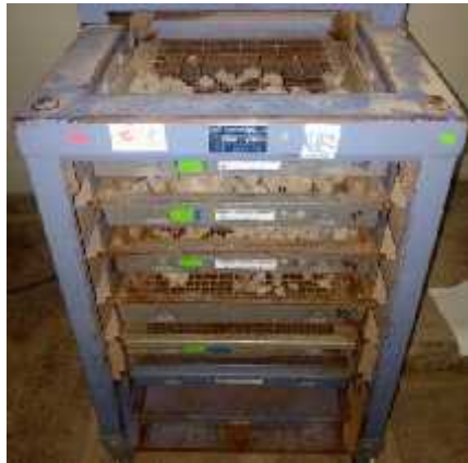
FIGURA F.3 Tamizado del agregado grueso para el ensayo de granulometría.
