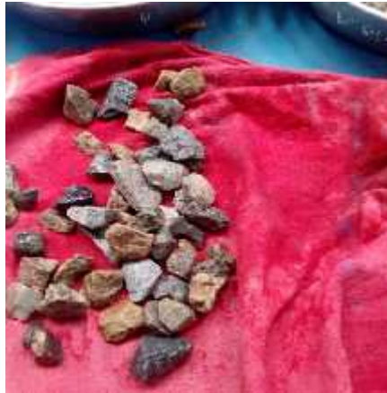
FIGURA F.3 Secado superficialmente seco del agregado grueso.
