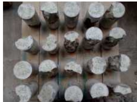
FIGURA F.3 Probetas de concreto después de las pruebas en estado endurecido.
