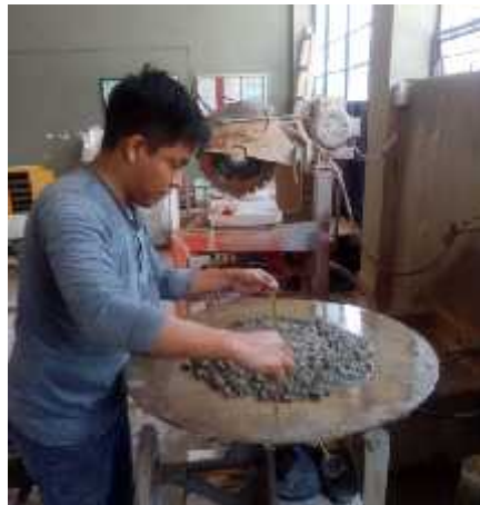
FIGURA F.3 Toma de medidas para la prueba de fluidez del concreto.
