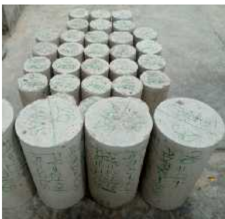
FIGURA F.3 Probetas desmoldadas y marcadas, listas para el curado en poza de agua.
