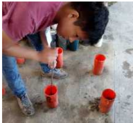
FIGURA F.3 Proceso para la elaboración de probetas de concreto.
