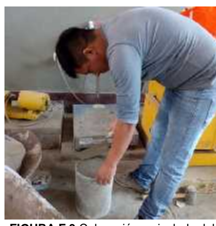
FIGURA F.3 Colocación y nivelado del concreto para el ensayo de peso unitario.
