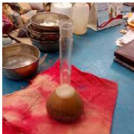
FIGURA F.5 Eliminación de aire contenido en el agregado fino por el método de la fiola.
