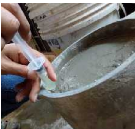
FIGURA F.3 Absorción del agua del concreto correspondiente a la prueba de exudación.
