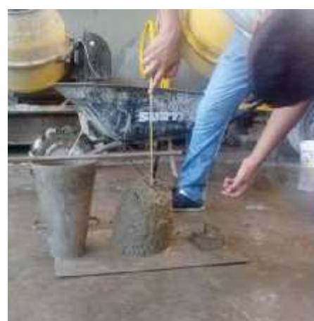
FIGURA F.3 Toma de asentamientos para el diseño del agua patrón.
