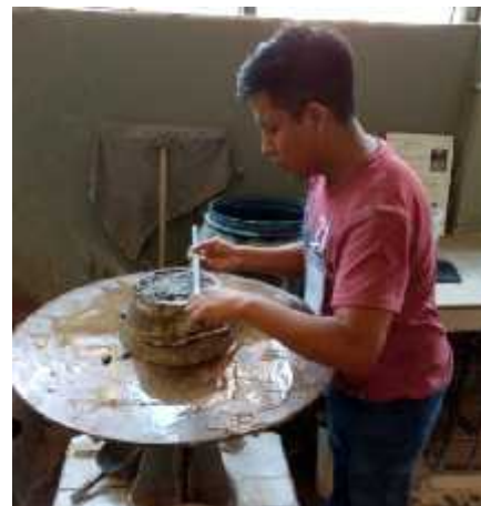
FIGURA F.7 Nivelación del concreto para la prueba de fluidez.
