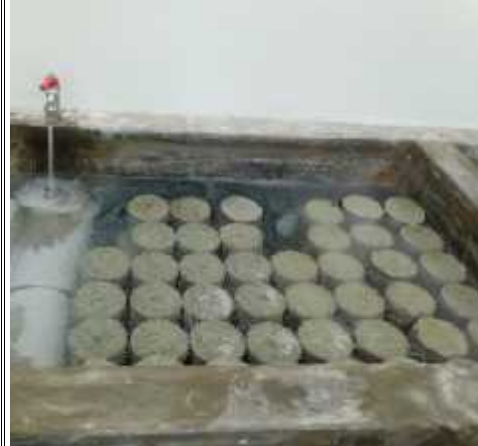
FIGURA F.3 Proceso de curado de las muestras de concreto por inmersión en una poza con agua.
