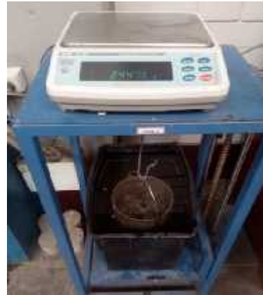
FIGURA F.4 Peso del agregado grueso saturado superficialmente seco.
