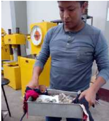
FIGURA F.7 Retiro de los agregados después del secado en el horno.
