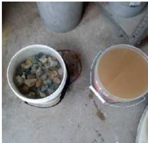
FIGURA F.1 Inmersión en agua del agregado fino y grueso por 24 horas para los ensayos a los agregados.
