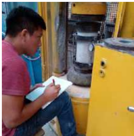
FIGURA F.3 Toma de las medidas en el ensayo de modulo elástico.
