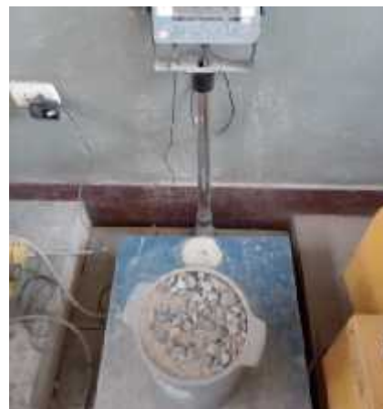
FIGURA F.8 Peso del agregado global para el cálculo del peso unitario.
