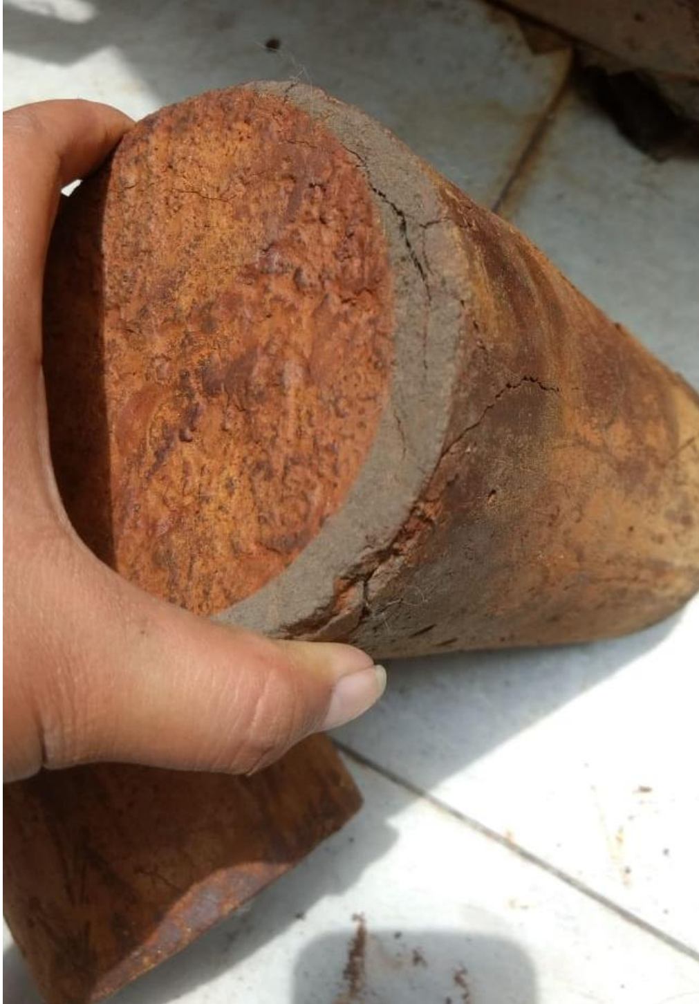
Foto 6. Bordes desprendidos en muestras ensayadas
