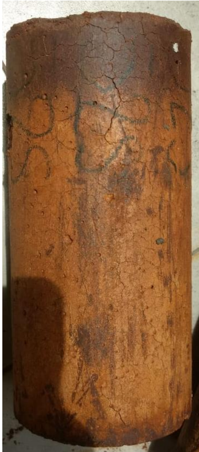
Ciclo 15: Aparición de grietas tipo polígonos cerrados
