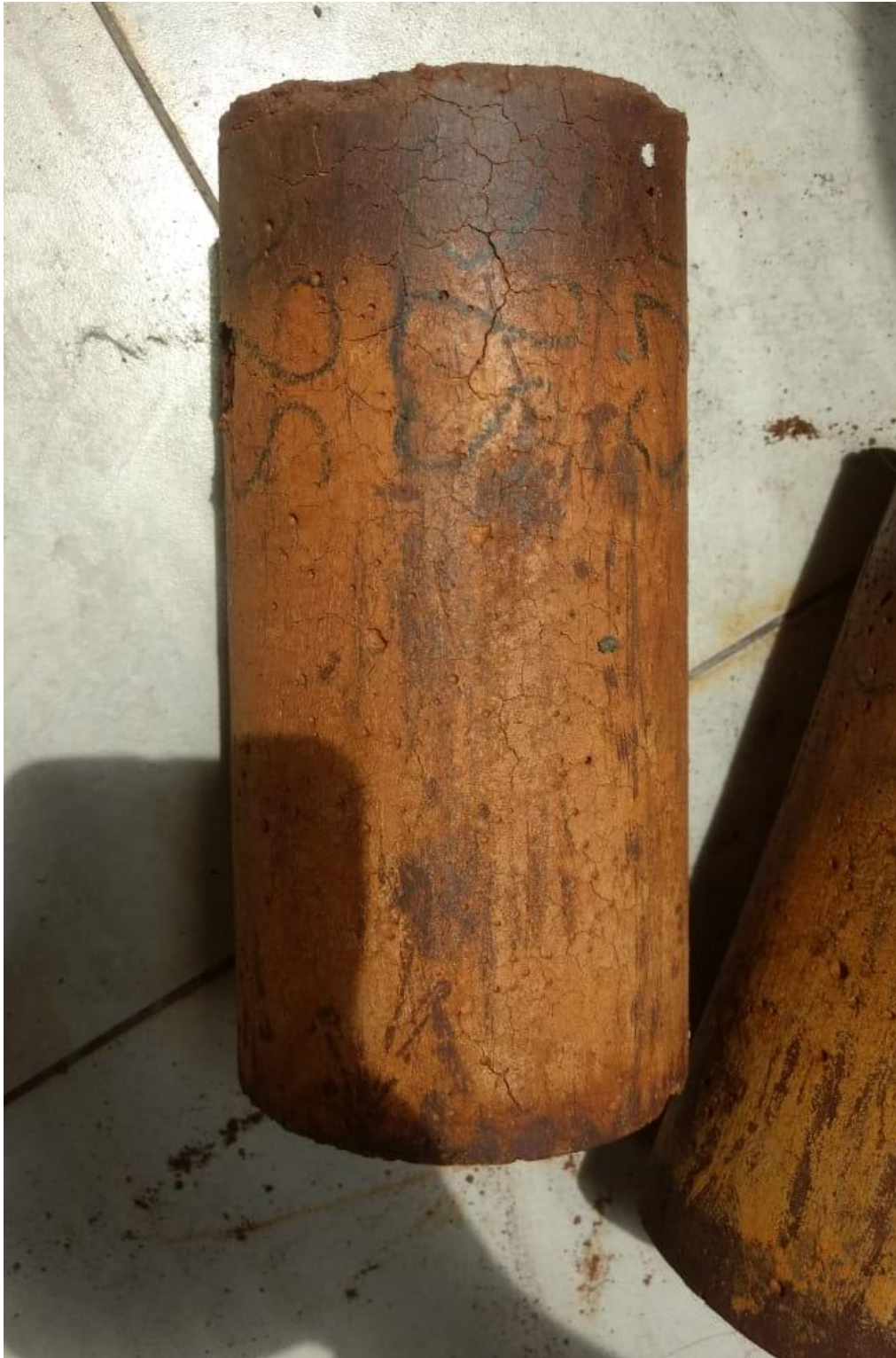
Foto 4. Agrietamiento en muestras
