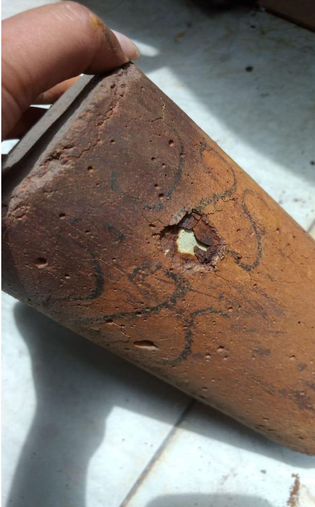
Foto 7. Superficie desprendida en muestras ensayadas
