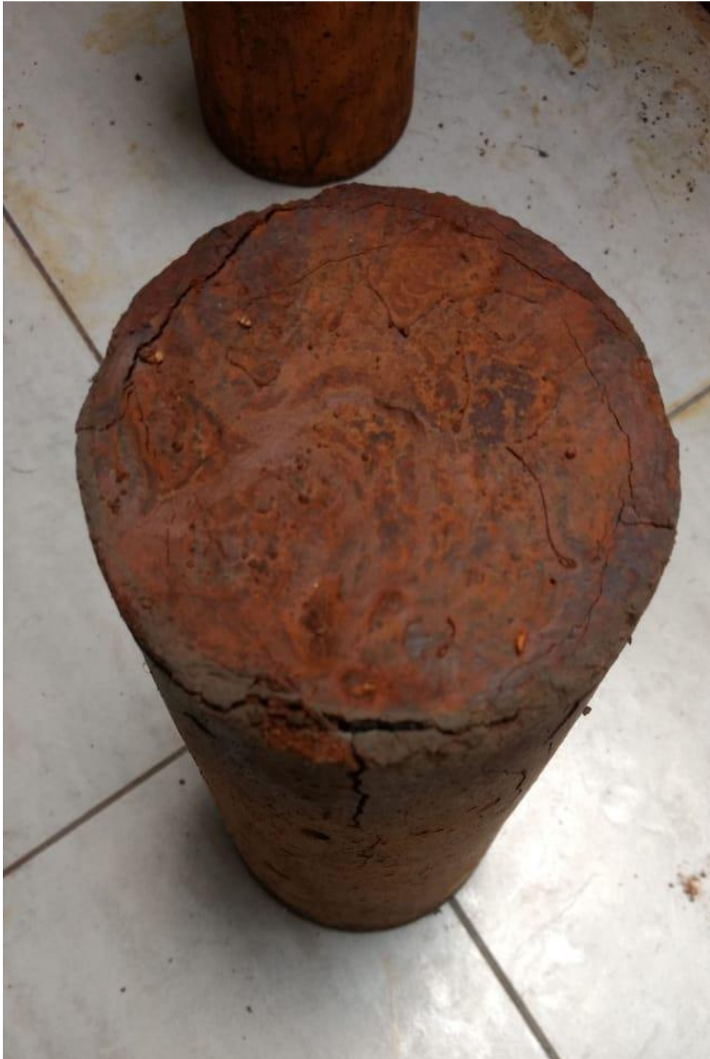
Foto 9. Grietas e hinchazón en bordes.
