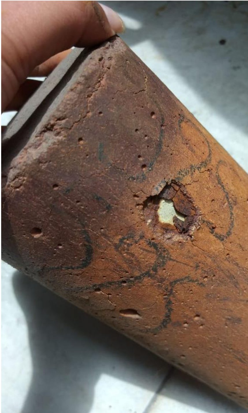
Al término del ensayo: Desprendimiento de capas superficiales
