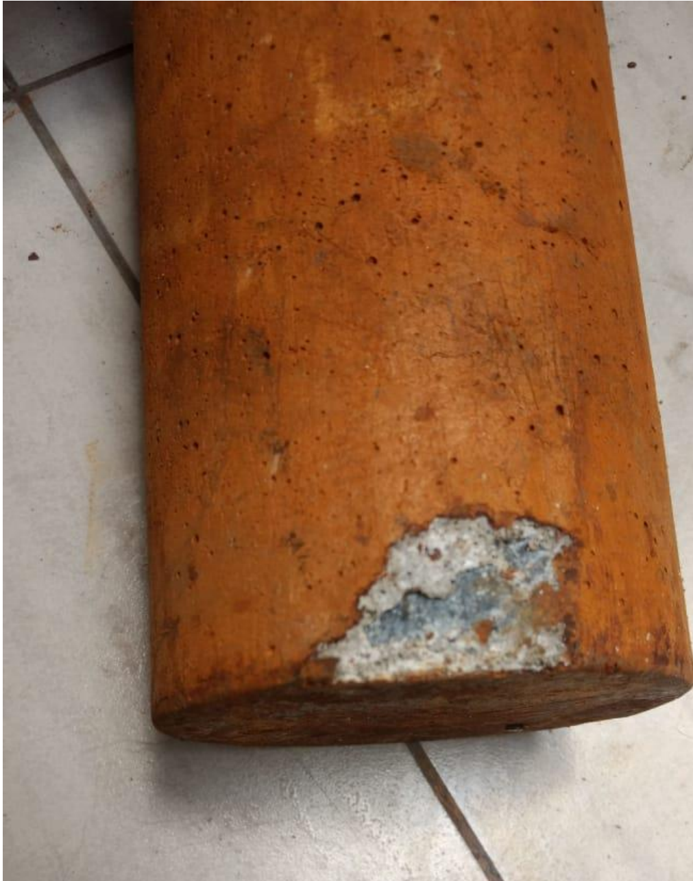
Foto 8. Desprendimiento de capa superficial.
