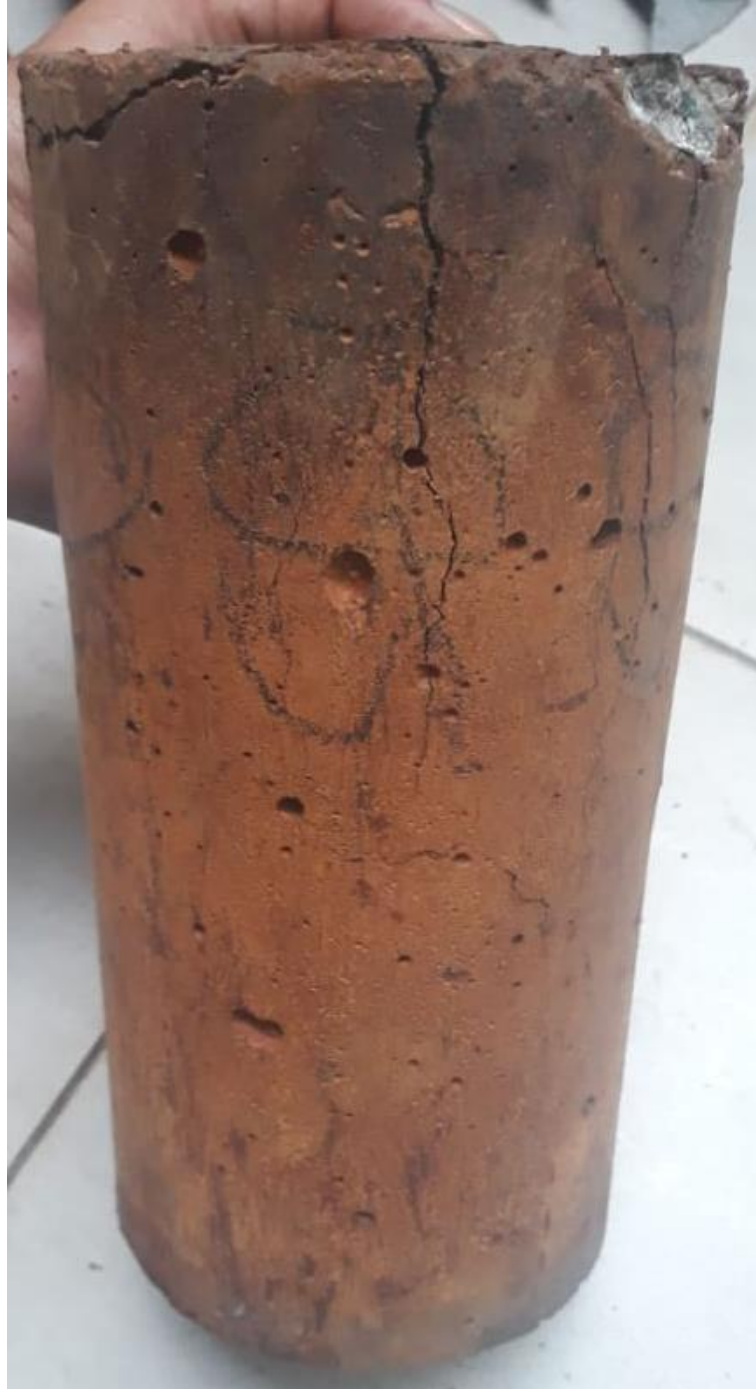
Al término del ensayo: Desprendimiento de capas superficiales
