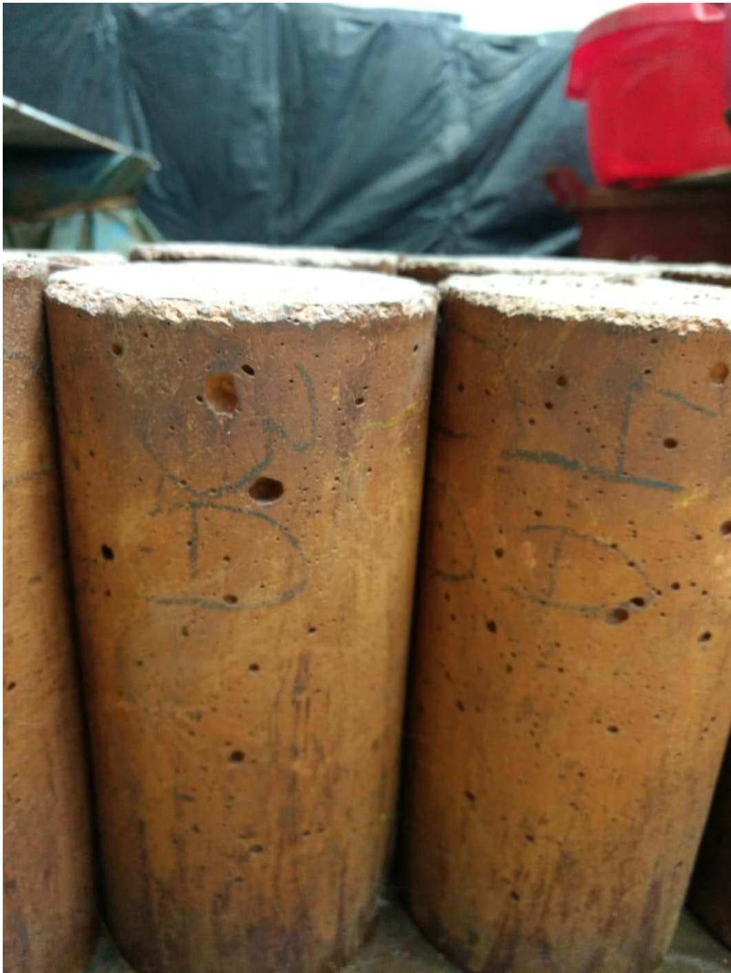
Foto 3. Picaduras y fisuras longitudinales
