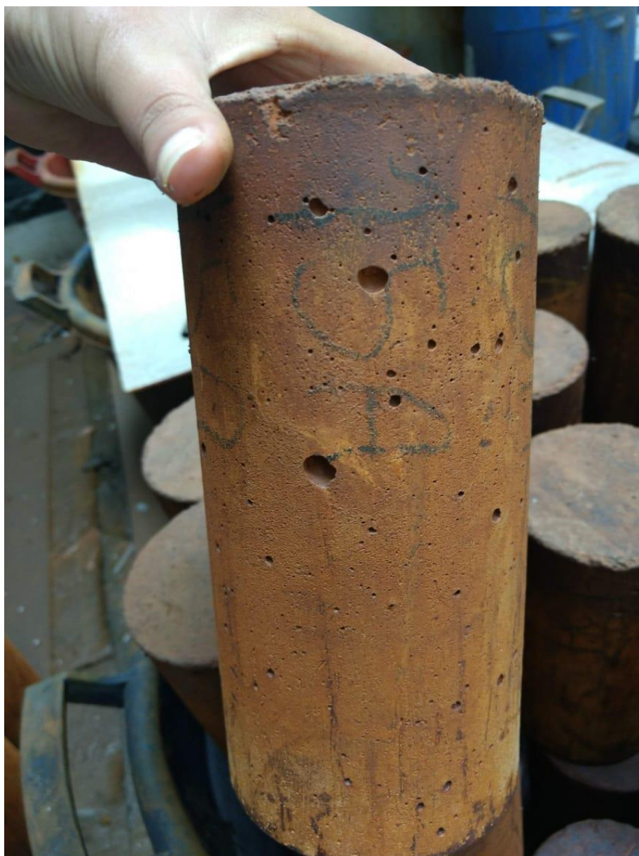
Foto 2. Picaduras en muestras ensayadas
