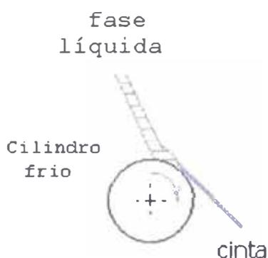
Figura 4.1 Representación esquemática de la preparación de muestras amorfas por la técnica de *melt spinning*.
