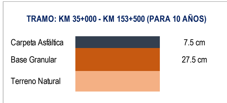
Figura N°2.5 Estructura del Pavimento Carretera Moquegua – Omate. Fuente: Propia del autor.
