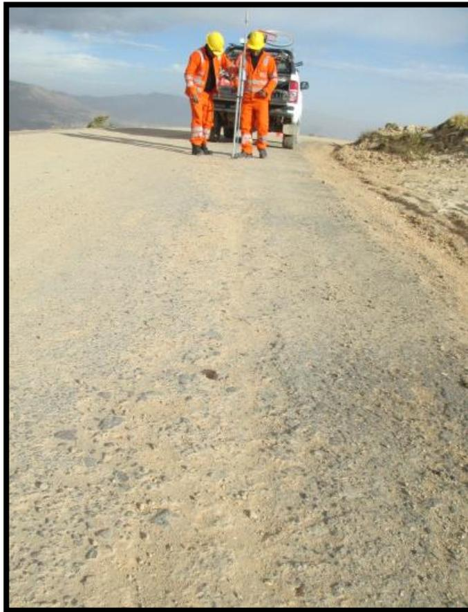
Figura N°31: Ensayo PDC para determinación de CBR in situ. Fuente: Elaboración propia.
