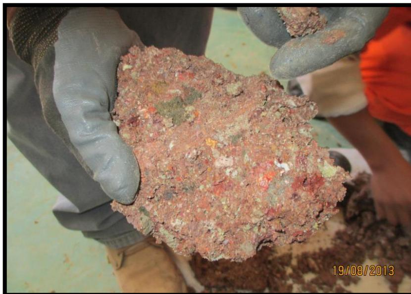
Figura N°20: Detalle de agregado tratado con Terrasil luego de ensayo CBR. Fuente: Elaboración propia.
