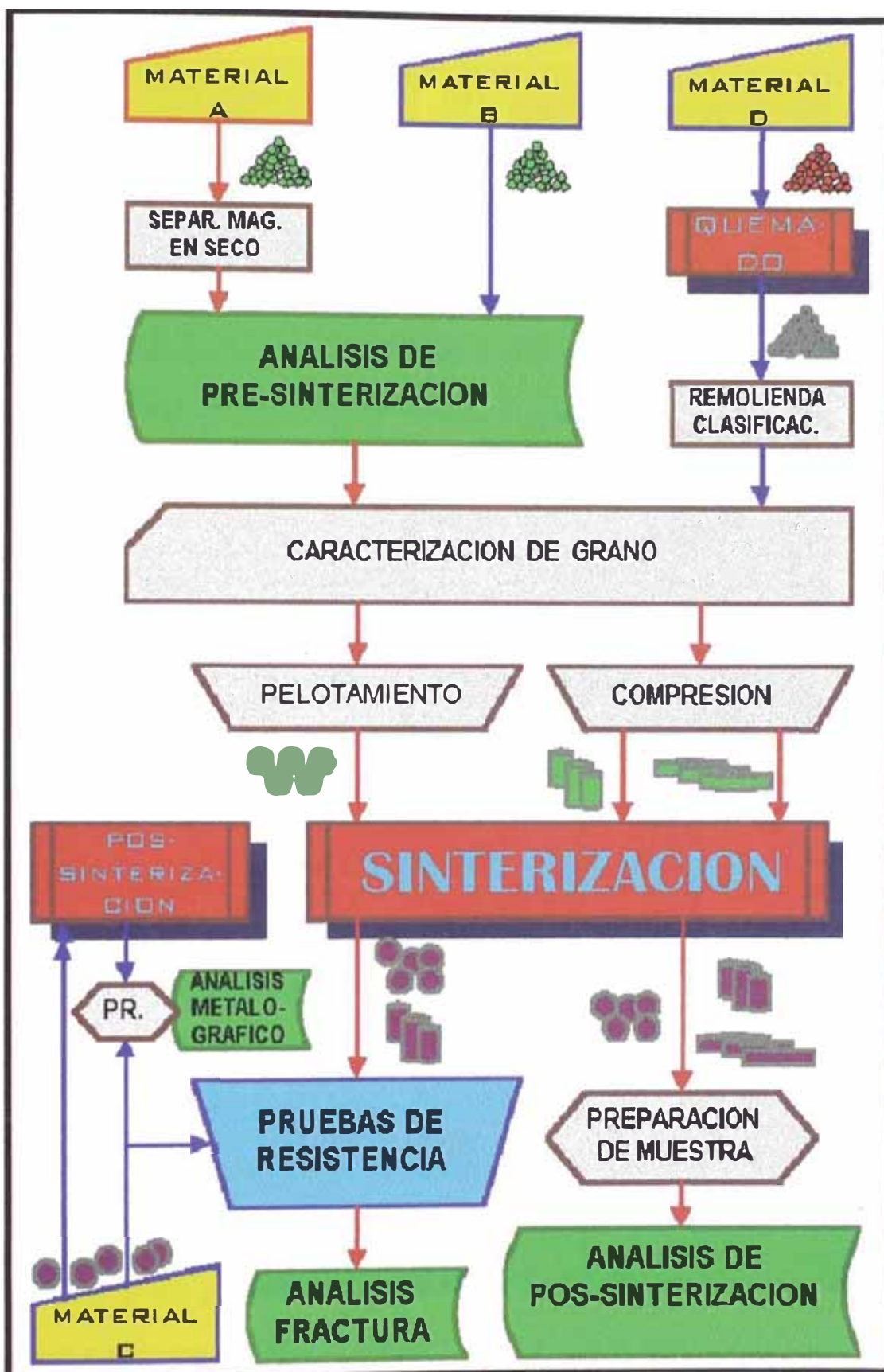
Fig. 3.1 Esquema del Plan Experimental de sinterización de concentrados magnéticos.
