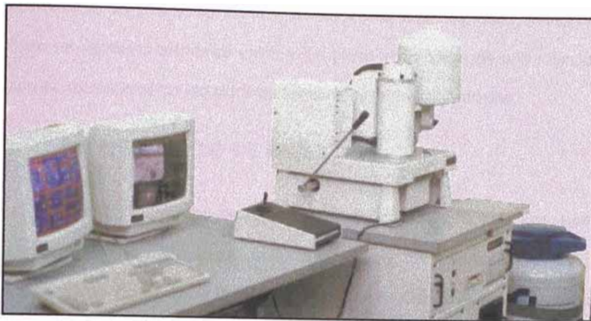
Fig. 3.15 MEB de la PUCP para hacer análisis metalográfico y Microanálisis Dispersivo en Energía.
