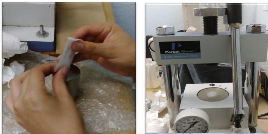
Figura 40 (b). Preparación del producto en pastilla, realizado en una prensa marca Perkin Elmer.
