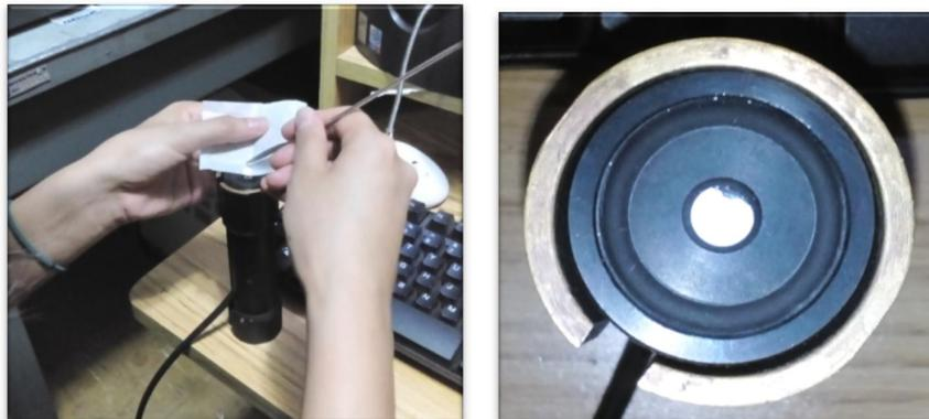
Figura 52. Colocación de la pastilla en el sensor del espectrómetro Cary 5000
