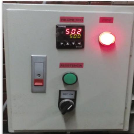
Figura 34. Horno a la temperatura de ensayo de 500°C. La indicación en amarillo representa la temperatura configurada y la indicación en rojo, la temperatura al interior del horno.
