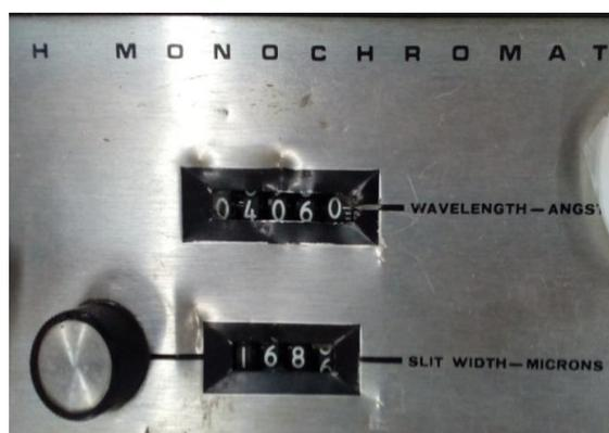
Figura 58. Monocromador. Rango visible. Resolución: 0,1 nm
