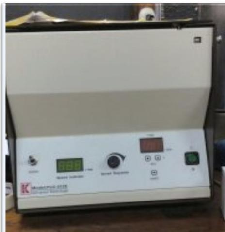
Figura 29. Centrifugadora. Para la separación del producto posterior a la etapa del lavado.
