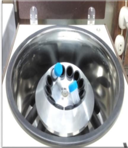
Figura 35. Centrifugado de las muestras obtenidas. Los tubos de ensayo se encuentran colocados diametralmente opuestos para no dañar el equipo.
