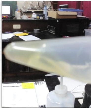
Figura 37. Precipitado. Se muestra el precipitado después de varios lavados y centrifugados. Se puede observar el aspecto gelatinoso y de color blanco.
