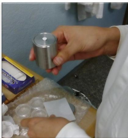
Figura 41. Muestra en pastilla. La forma lograda es cilíndrica y dependiente de la granularidad conserva su rigidez para ser manipulada.
