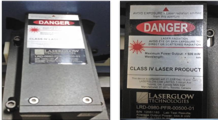
Figura 56. Láser de excitación del FluoroMax-P. Longitud de onda 980 nm
