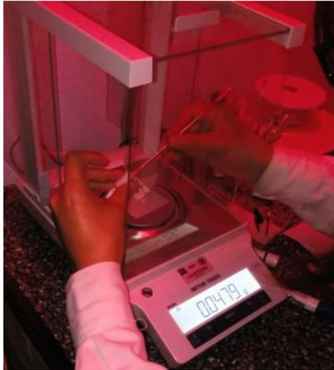
Figura 39. Pesado de la muestra para preparación de pastilla. Se utilizó balanza de laboratorio con urna, nivelada y verificada.
