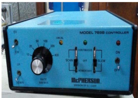
Figura 59. Controlador de longitud de onda. Desde 10 nm/min hasta 400 nm/min
