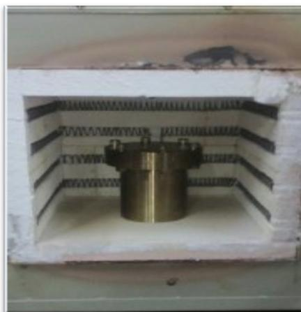
Figura 33. Colocación de la autoclave en el horno para el tratamiento térmico.
