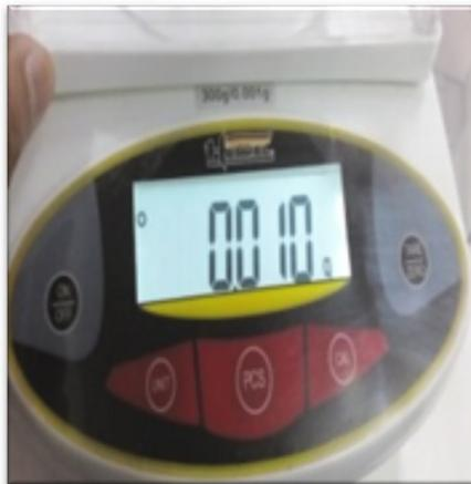
Figura 26. Balanza de laboratorio. Cuenta con urna para evitar las fluctuaciones por corrientes de aire, burbuja de nivelación e indicador de estabilidad en el pesado.
