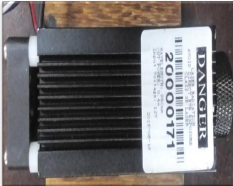
Figura 43. Láser de 980 nm
