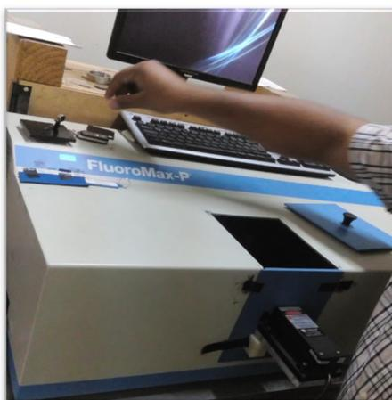
Figura 53. Espectrofluorímetro del CINVESTAV. Se muestra el equipo, la colocación del láser y un pc con software FluorEssence para la visualización de resultados.
