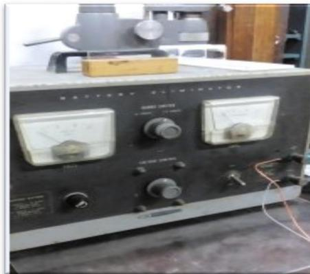
Figura 44. Fuente de voltaje DC variable hasta 12 V. Para la regulación de la potencia del láser.
