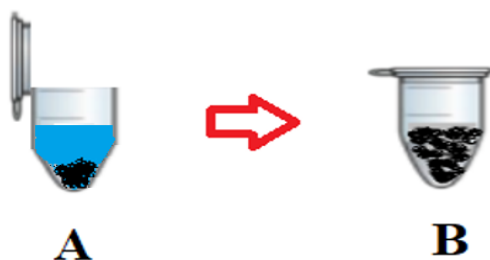
Figura 29. Esquema de la formación de la tinta, A) Sensor sintetizado, adicionado en la solución de agua/nafión y B) Tinta, dispersión del sensor sintetizado.
