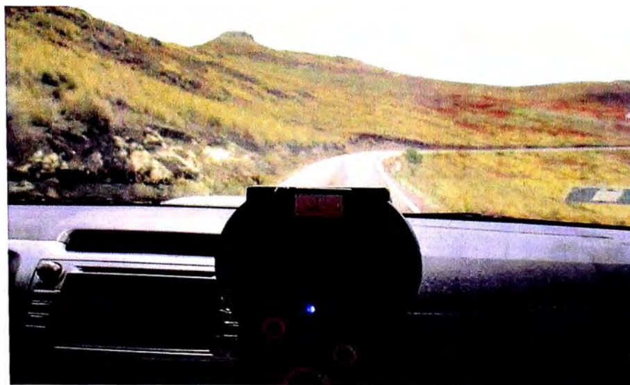
Figura N° 51 Inicio de medición de rugosidad con velocidades entre 40 y 60 km/hr.
