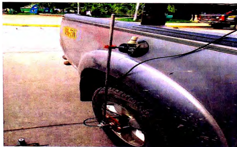
Figura N° 47 Instalación del odómetro.
