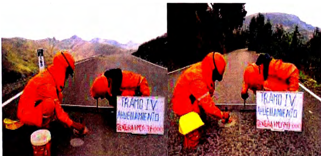
Figura N° 95 Medición de macrotextura con círculo de arena Tramo IV.
