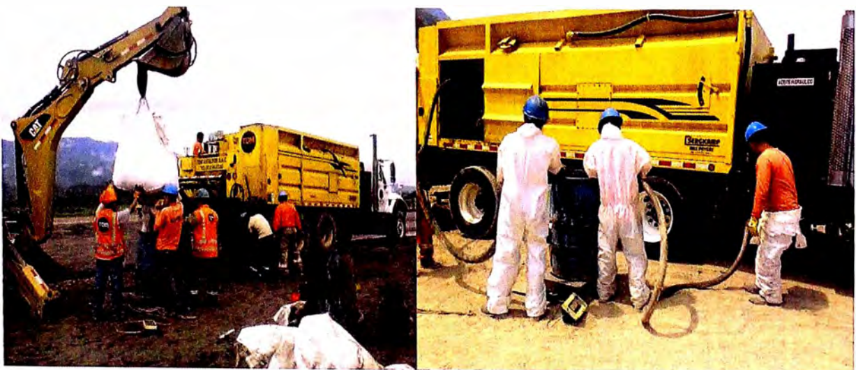
Figura N° 10 Calibración de camión micropavimentador Berkamp.
