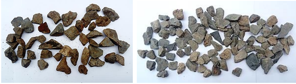
Fotografía 10.24 Piedra chancada con biofilm (izquierda) y sin biofilm (derecha)
