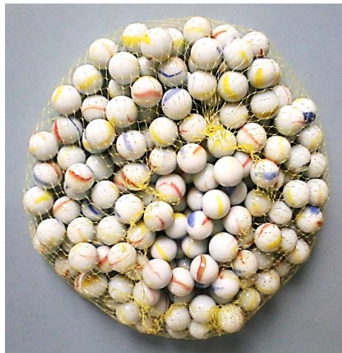
Fotografía 10.11 Canicas colocadas en la base de los filtros.
