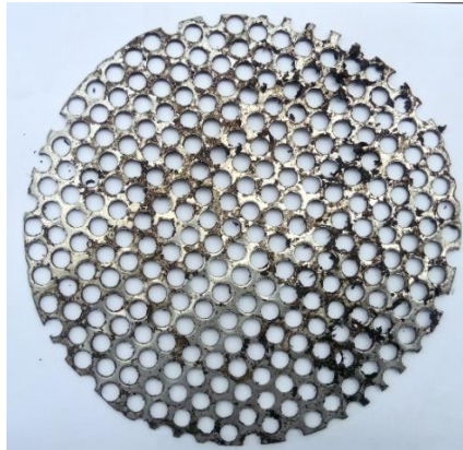
Fotografía 10.10 Círculo de plancha perforada de acero inoxidable para base del medio de soporte.
