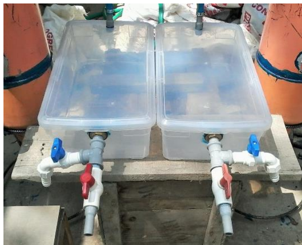
Fotografía 10.12 Taper de 10 litros plástico adaptado como sedimentador.
