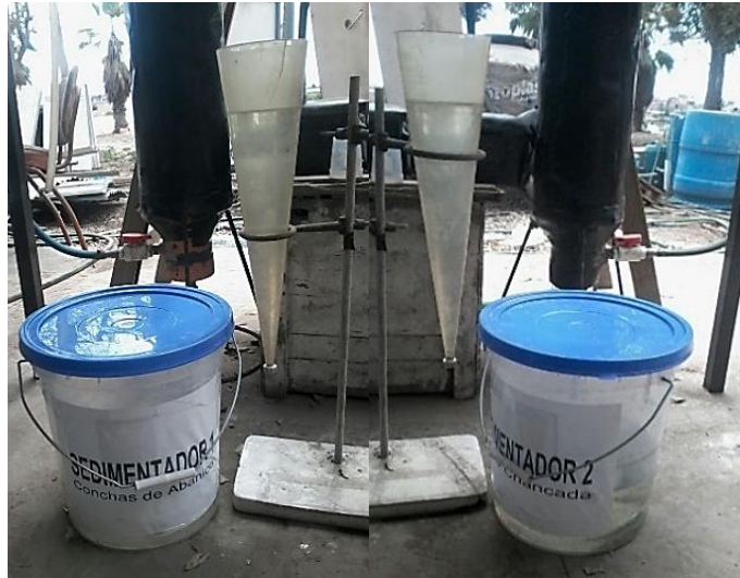
Fotografía 6.3 Medición de sólidos sedimentables
