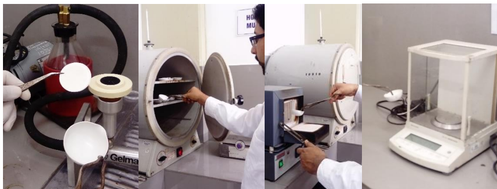
Fotografía 10.18 Análisis en laboratorio de Sólidos Suspendidos Volátiles.
