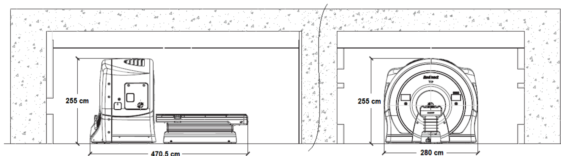
Figura 28: Vista lateral y frontal del equipo de tomoterapia en el que se indican sus dimensiones [4].
