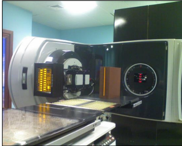
Figure 24: NOMOS Peacock instalado en un acelerador Varian 6/100. En la foto se muestra parte del proceso de control de calidad del sistema. Foto del Autor.
