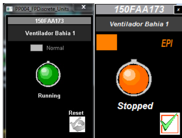
Figura 3.36. Faceplate de monitoreo de equipos (ventana emergente). La parte de la izquierda es del Scada (pc-based) y el de la derecha es del terminal gráfico. Se muestra el TAG de equipo de proceso, la indicación de estado del interlock, indicación del estado en que se encuentra. Adaptado del Proyecto desarrollado.
