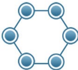
Figura 2.29. Nodos en topología tipo anillo. Adaptado de Network Topology. Recuperado de http://www.certiology.com/computing/computer-networking/network-topology.html
