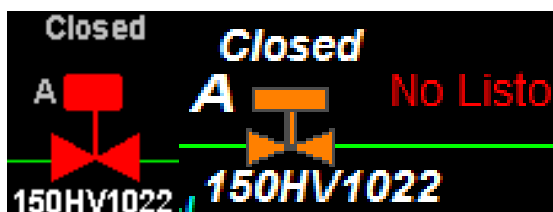
Figura 3.44. Objeto gráfico de válvula. La parte de la izquierda es del Scada (pc-based) y el de la derecha es del terminal gráfico. Se muestra una válvula con información del TAG del equipo, del estado que se encuentra, en qué modo de operación se encuentra. Adaptado del Proyecto desarrollado.
