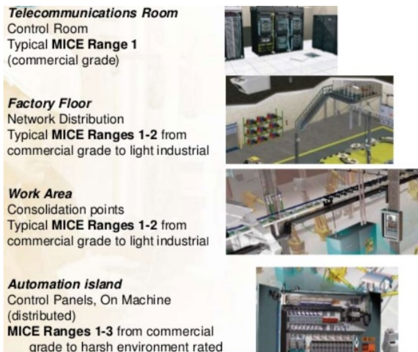
Figura 2.31. Rangos aplicables del MICE en diferentes situaciones ambientales. Adaptado de Industrial Ethernet, Part 1: Technologies. Recuperado de https://es.slideshare.net/ControlEng/industrial-ethernet-part-1-technologies
