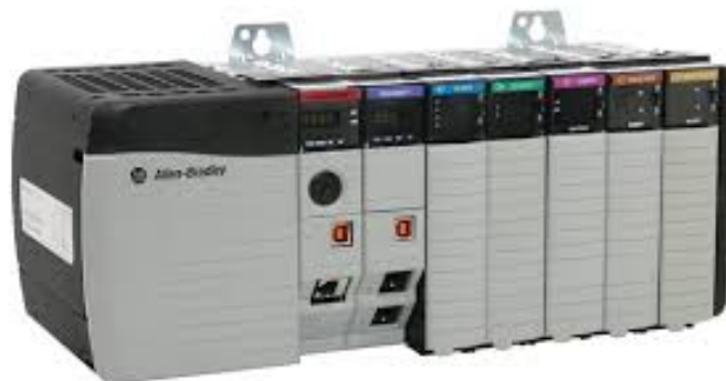
Figura 2.18. Controlador ControlLogix 5580. Incluyendo el backplane, fuente de alimentación, CPU, módulo de comunicación y I/Os. Adaptado de ControlLogix 5580 Controllers. Recuperado de https://literature.rockwellautomation.com/idc/groups/literature/documents/pp/1756-pp001_-en-p.pdf
