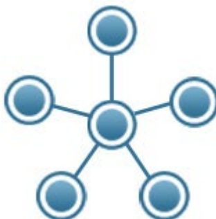
Figura 2.30. Nodos en topología tipo estrella. Adaptado de Network Topology. Recuperado de http://www.certiology.com/computing/computer-networking/network-topology.html
