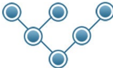
Figura 2.28. Nodos en topología tipo árbol. Adaptado de Network Topology. Recuperado de http://www.certiology.com/computing/computer-networking/network-topology.html
