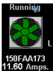
Figura 2.10. Representación de un ventilador axial en SCADA. Adaptado del Proyecto desarrollado.
