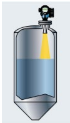
Figura 2.12. Instalación de sensor / Indicador de nivel tipo radar en un tanque. Adaptado del Catálogo Medición y Detección de nivel Endress+Hauser. Recuperado de https://www.mx.endress.com/es/instrumentacion-campo
