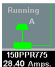
Figura 2.8. Representación de una bomba sumergible en SCADA. Adaptado del Proyecto desarrollado.
