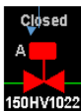
Figura 2.9. Representación de una válvula en SCADA. Adaptado del Proyecto desarrollado.
