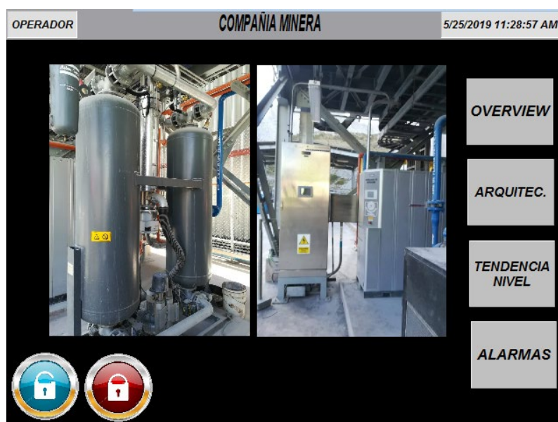
Figura 3.56. Pantalla de inicio - HMI Planta de Nitrógeno de la terminal gráfica. Adaptado del Proyecto desarrollado.
