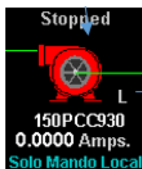
Figura 2.7. Representación de una bomba de alta presión en SCADA. Adaptado del Proyecto desarrollado.
