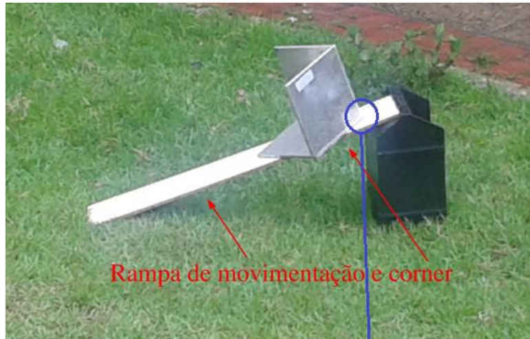
Figura 4.11. Reflector o corner utilizado para la validación de la metodología.
