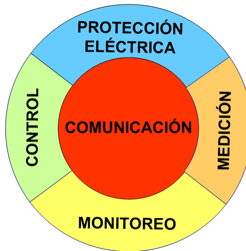
Figura 1.1. Estructura funcional automatización de subestaciones
