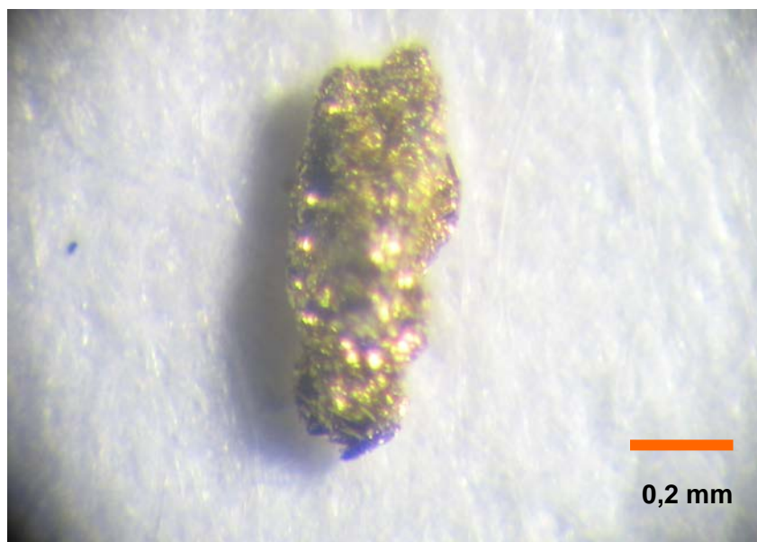
Fotografía N° 11-MA: Partícula de oro aluvial separado por medio gravimétrico (R. Abujao Ucayali-Perú).
