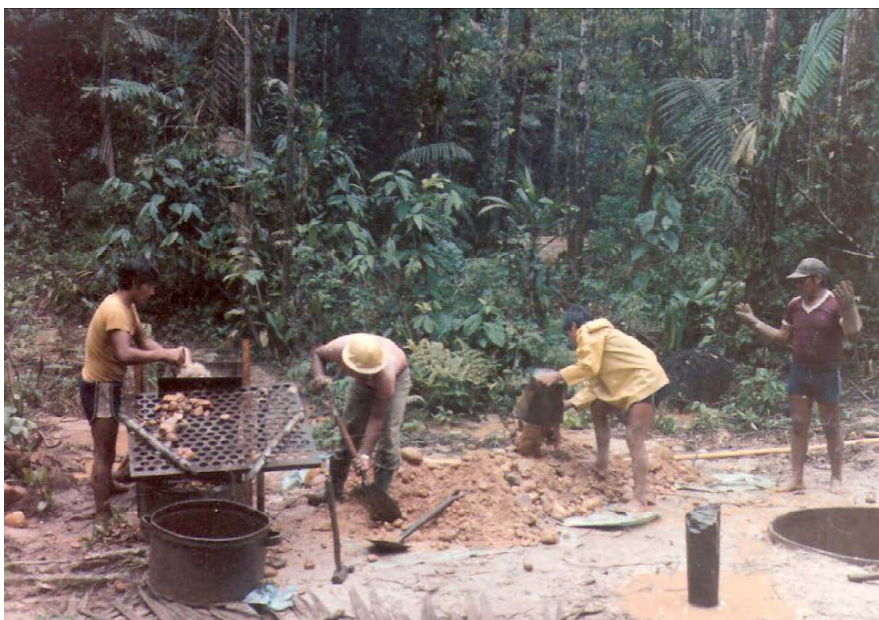
Fotografía Nº 11: Vista del proceso de pozos de comprobación mediante caissons y tratamiento en una planta piloto artesanal tamizando las gravas.
