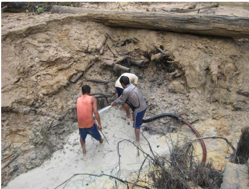
FOTOGRAFIA N° 15: En plena labor de minado con chupadera (Caranchera) sobre la roca base (Bed rock) en el río Shesha.
