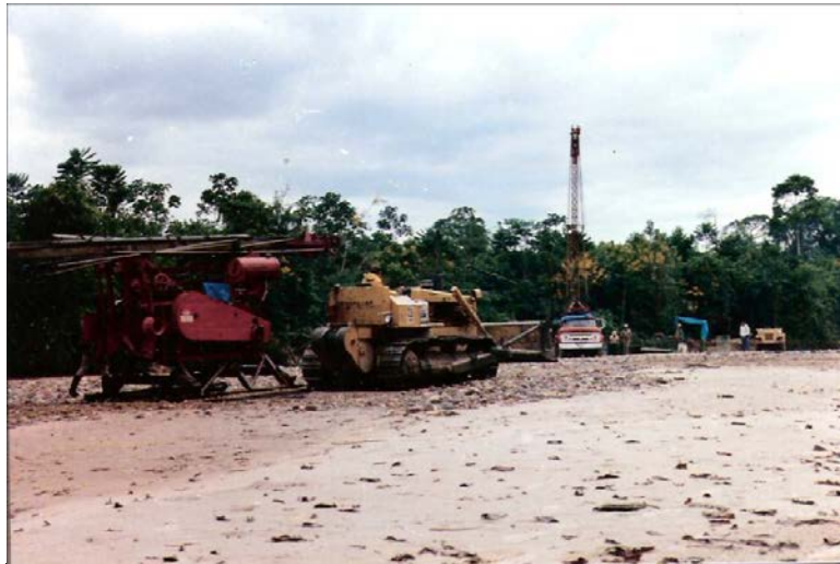
Fotografía N° 08: Perforadora Bucyrus Erie 20 W halada por tractor y modelo 22 W montada en camión en plena labor en un río del sur oriente peruano.
