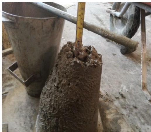
Figura A6.18 Medida de asentamiento en prueba de agua.
