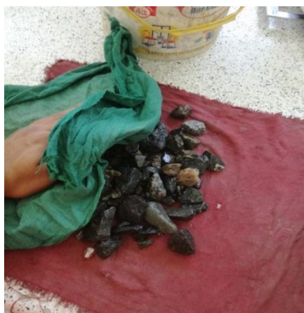
Figura A6.7 Secado de agregado grueso en ensayo de Peso específico y % de absorción.
