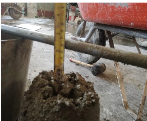
Figura A6.21 Medida de asentamiento en ensayo de consistencia.
