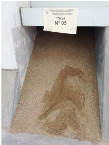
Figura A6.1 Agregado fino almacenado en tolva
