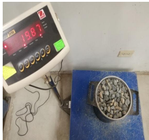
Figura A6.5 Pesado de agregado grueso en ensayo de Peso Unitario Compactado
