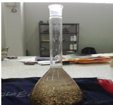
Figura A6.9 Reposo en Fiola de agregado fino en ensayo de Peso específico y % de absorción.
