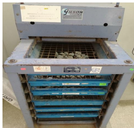
Figura A6.12 Zarandeo mecánico de agregado grueso en ensayo de granulometría.
