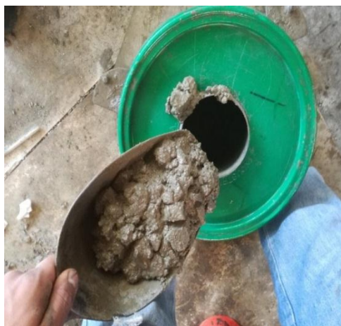
Figura A6.17 Llenado de cono de Abrams en prueba de agua.
