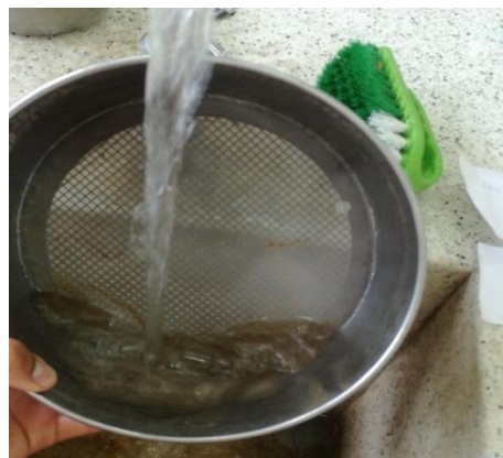
Figura A6.11 Lavado de agregado fino en ensayo de material que pasa malla N°200.
