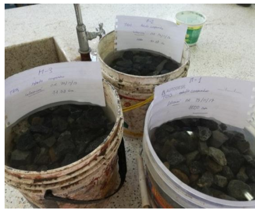
Figura A6.6 Saturación de agregado grueso en ensayo de Peso específico y % de absorción
