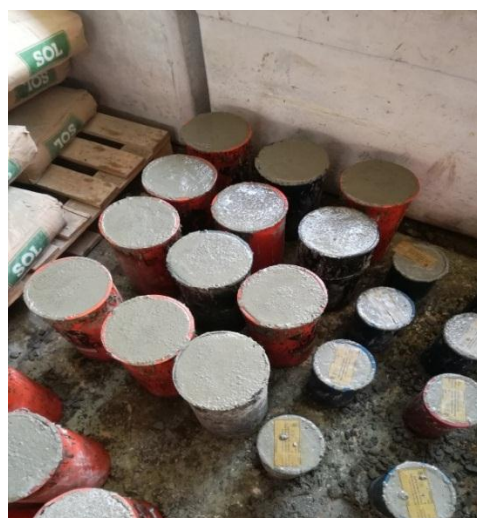
Figura A6.27 Mezclas en probetas listas para llevar al pozo de curado.
