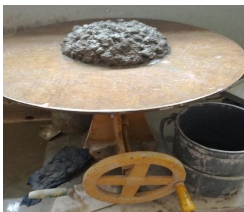
Figura A6.24 Mezcla en mesa de sacudidas en ensayo de fluidez.
