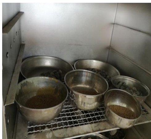
Figura A6.10 Secado de agregado grueso y fino en ensayo de contenido de humedad.
