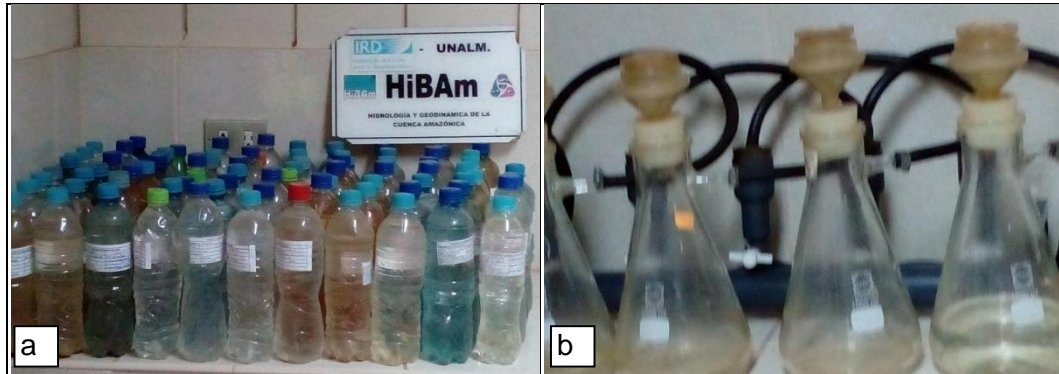
Muestras de los sedimentos en suspensión recogidas en recipientes de 500ml-700ml. Muestras del año 2017
