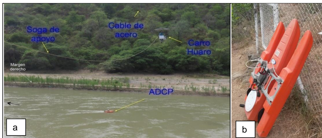
Figura 34. Medición de las velocidades: a) Aforo, b) ADCP
