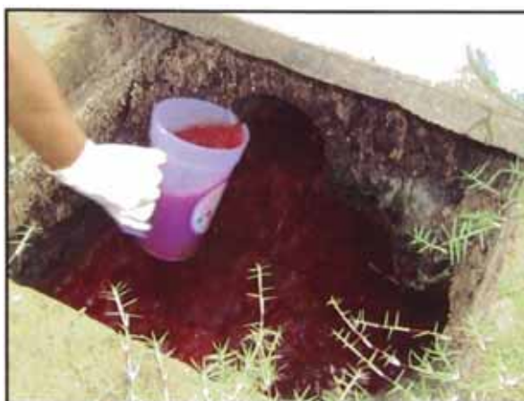
Foto N° 4.3: Toma de Muestra de Agua Residual
