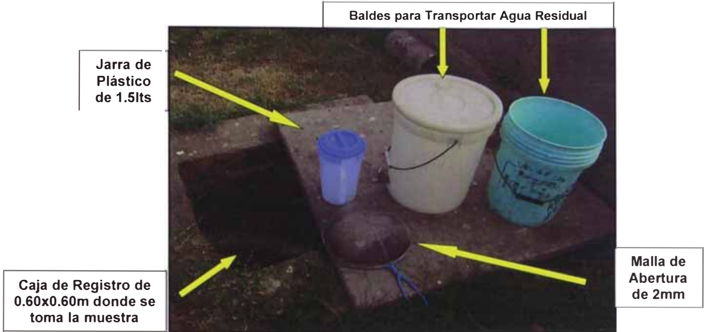
Foto N° 4.7: Ubicación y Materiales para Captación del Agua Residual
