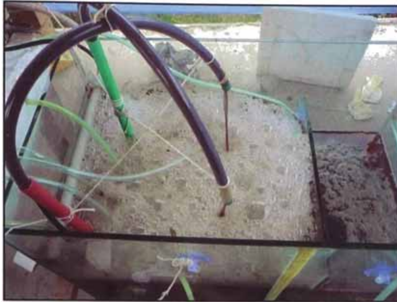
Foto N° 4.21: Inyección de aire por medio de Chorro
