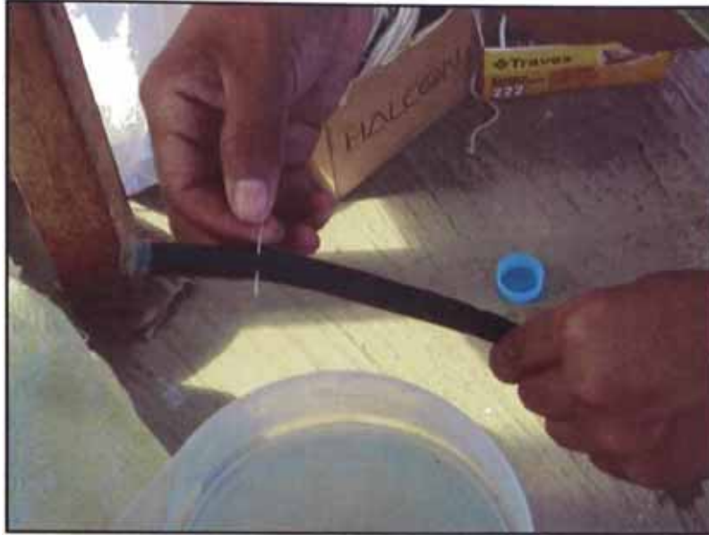
Foto N° 4.15: Difusor de Jebe Agujerado
