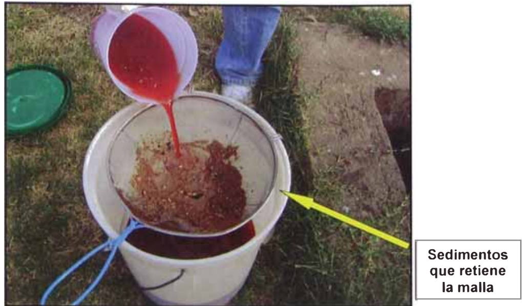
Foto N° 4.9: Vertido del Agua Residual a través de la Malla Metálica
