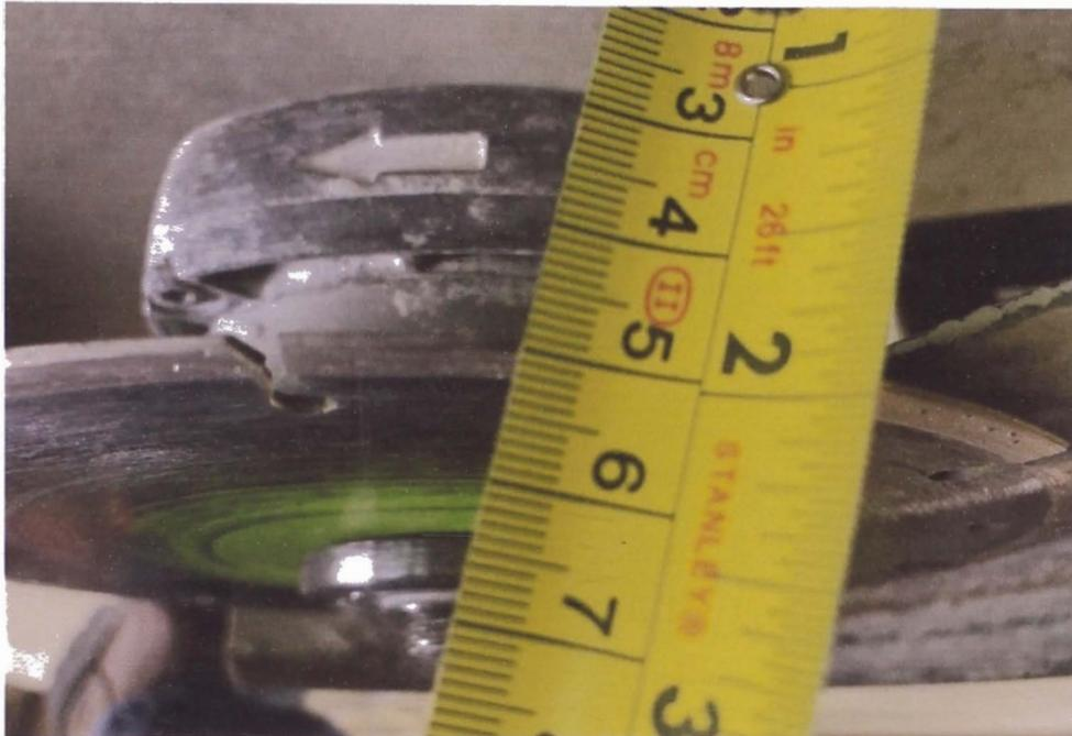
Figura N° 58 Amoladora para perfilado con disco de 4 mm.
