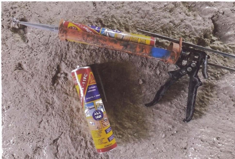
Figura N° 59 Aplicador y tubo de material elastomérico.
