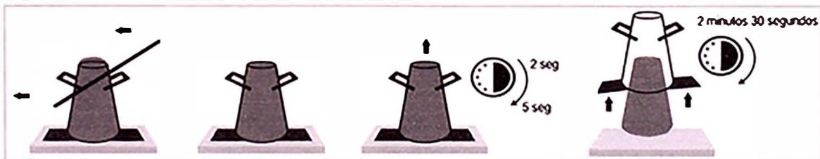
Figura N° 16 Tiempo de espera y método para retiro de molde cónico trunco.
