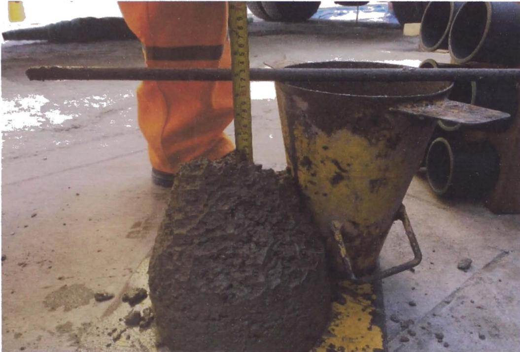
Figura N° 18 Prueba de cono de Abrams con slump de 6".
