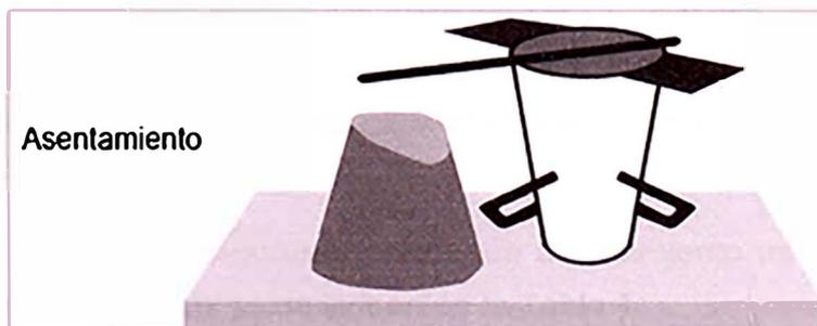
Figura N° 17 Determinación del slump, medición de asentamiento del concreto ensayado.
