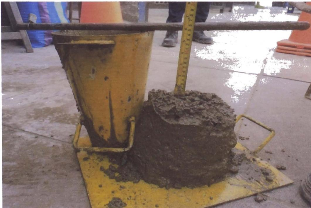
Figura N° 19 Prueba de cono de Abrams con slump de 5".
