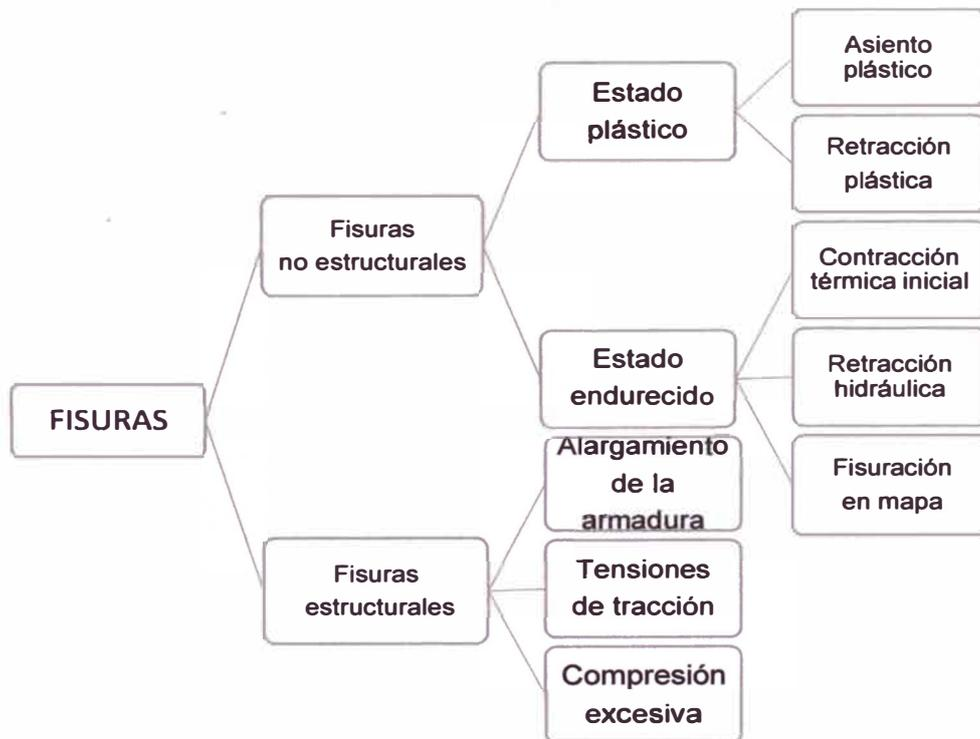
Figura N° 31 Clasificación de fisuras estructurales y no estructurales.
