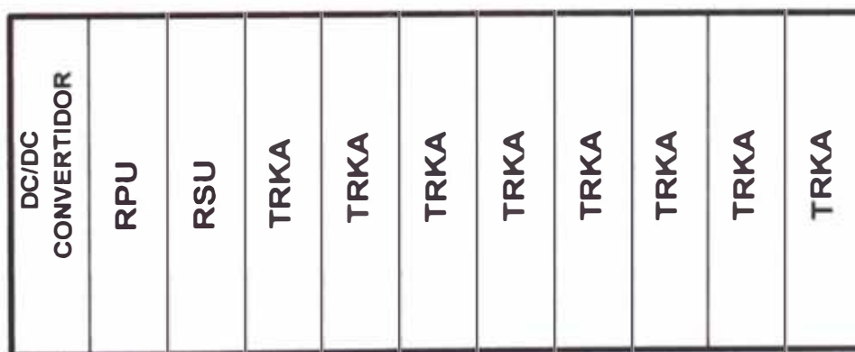
Figura 4.3 Estructura Del Bastidor Del Sub-Módulo De Troncales Analógicas
