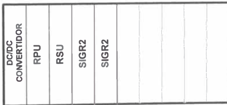
Figura 6.3 RACK DEL SUB MODULO DE SEÑALIZACION
