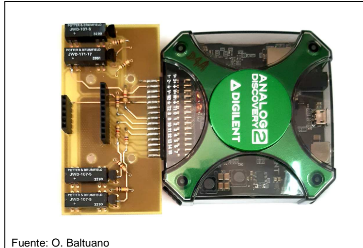
Fuente: O. Baltuano Figura 16. Tarjeta selectora de resistencia de shunt fabricada para el espectrómetro y acoplada con módulo AD2
