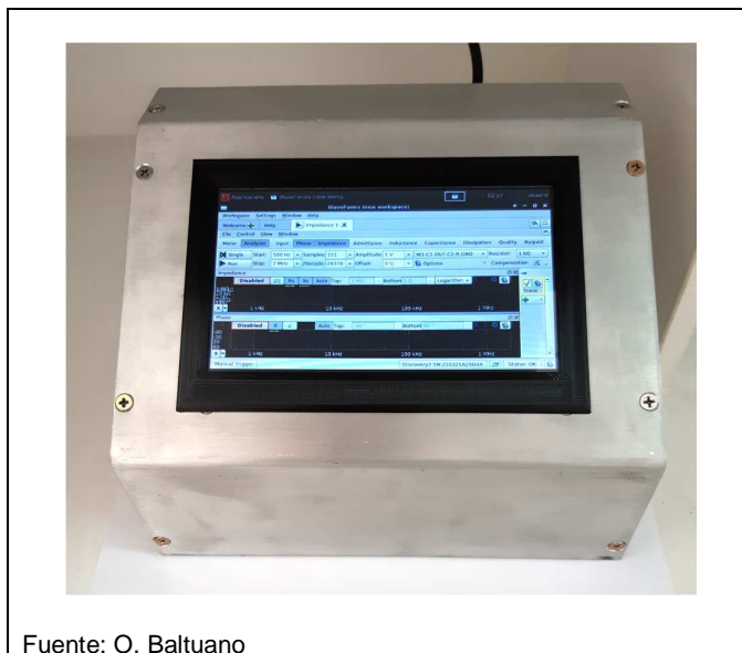
Figura 23. Imagen de la parte frontal del equipo mostrando la pantalla TFT para interacción con el usuario y el software Waveforms cargado para entorno Armbian.
