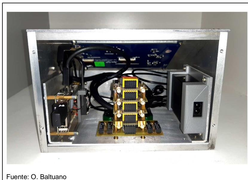
Figura 25. Imagen de la parte posterior del equipo descubierta sin tapa. En primer plano se muestran los conectores SMA para los 4 electrodos.
