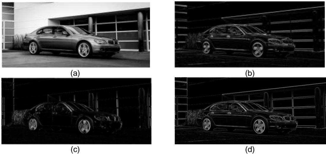
Figura 2.11. (a) Imagen original, (b) derivada vertical de la Imagen “(a)”, (c) derivada horizontal de la imagen “(a)” y (d) magnitud de la gradiente (Brehar [2]).
