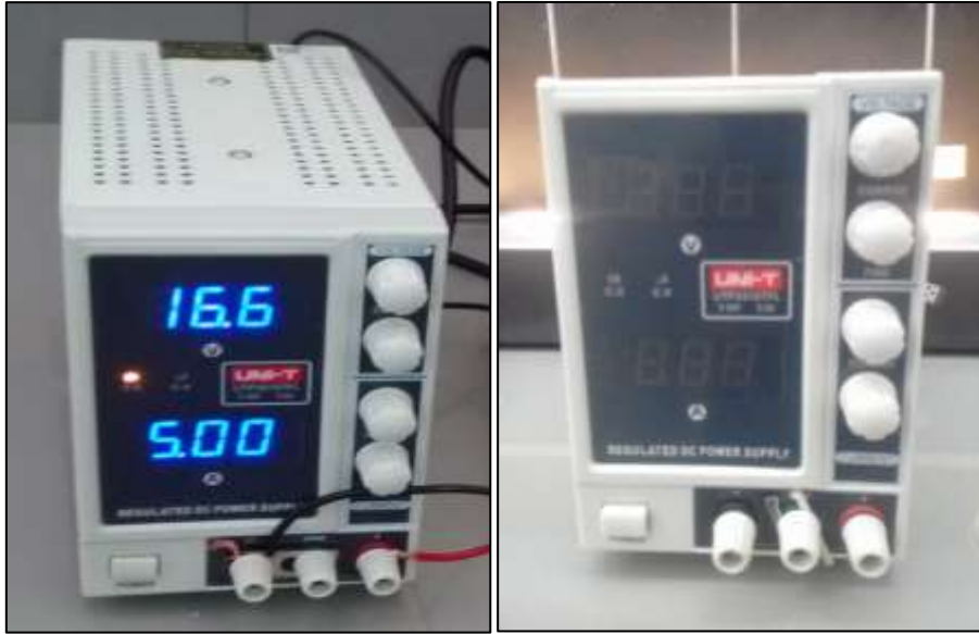
Figura 6. Fuente de poder o fuente de alimentación digital UNI-T UTP-3315TFL, corriente continua DC 0-30V y de 0-5A.
