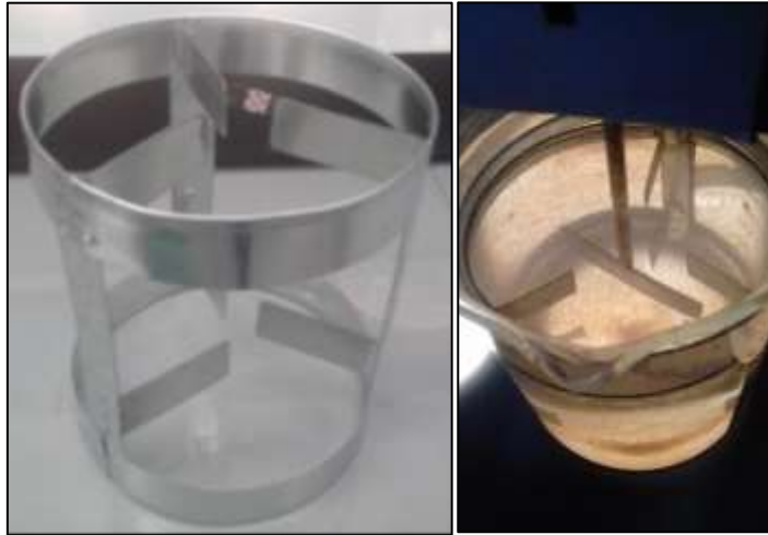
Figura 10. Los deflectores influyen en forma decisiva en la eficiencia del ensayo de sedimentación.
