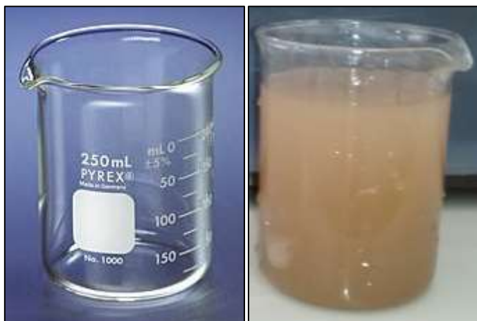
Figura 12. De borosilicato, con pico, con espesor de pared uniforme.
