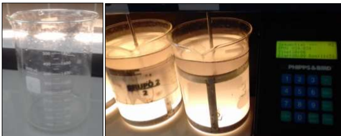
Figura 9. Vasos precipitados y su trabajo en el desarrollo en la prueba de jarras.
