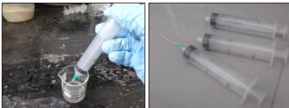
Figura 13. De capacidad de 20 ml, las agujas permiten cargar hasta el más mínimo volumen de coagulante de los vasos de 50 ml.
