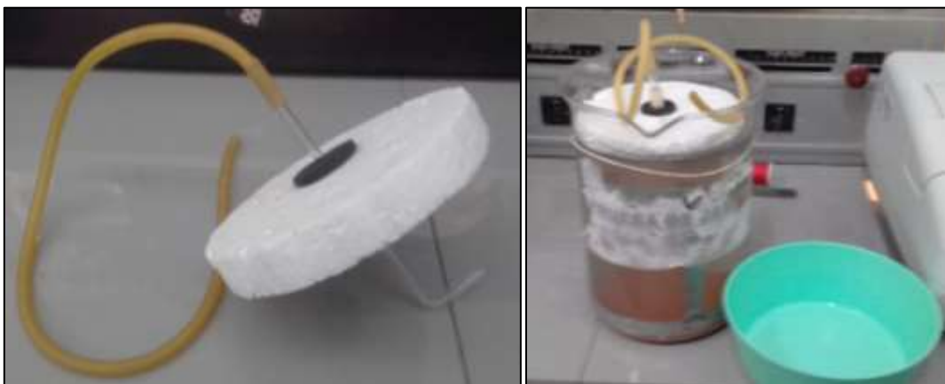
Figura 11. El sifón de vidrio descansa sobre la estabilidad del tecnopor para el muestreo.
