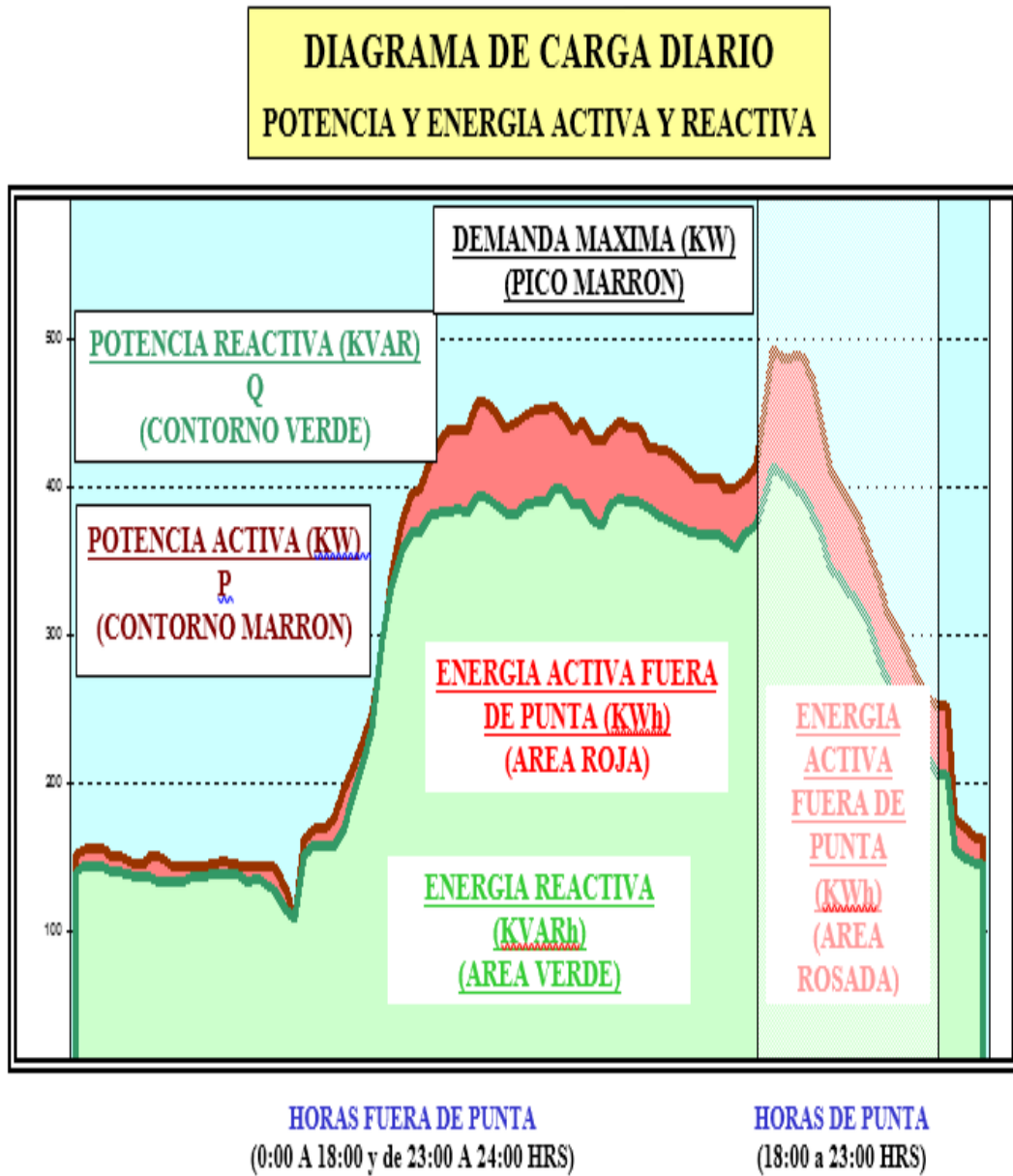
Figura 11. Diagrama de carga diario potencia y energía activa comparativa Fuente: Oficina Central de Servicios Generales
