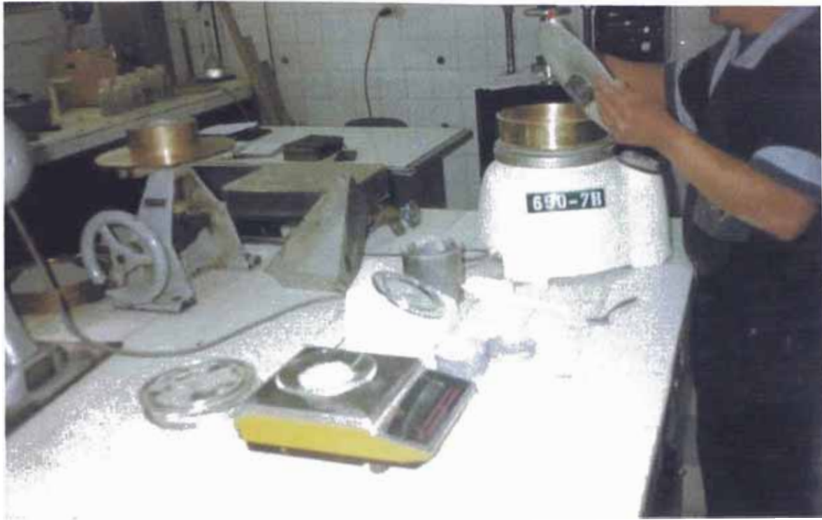
FOTO No 3 TAMIZADO DEL CEMENTO PORTLAND TIPO V - ANDINO
