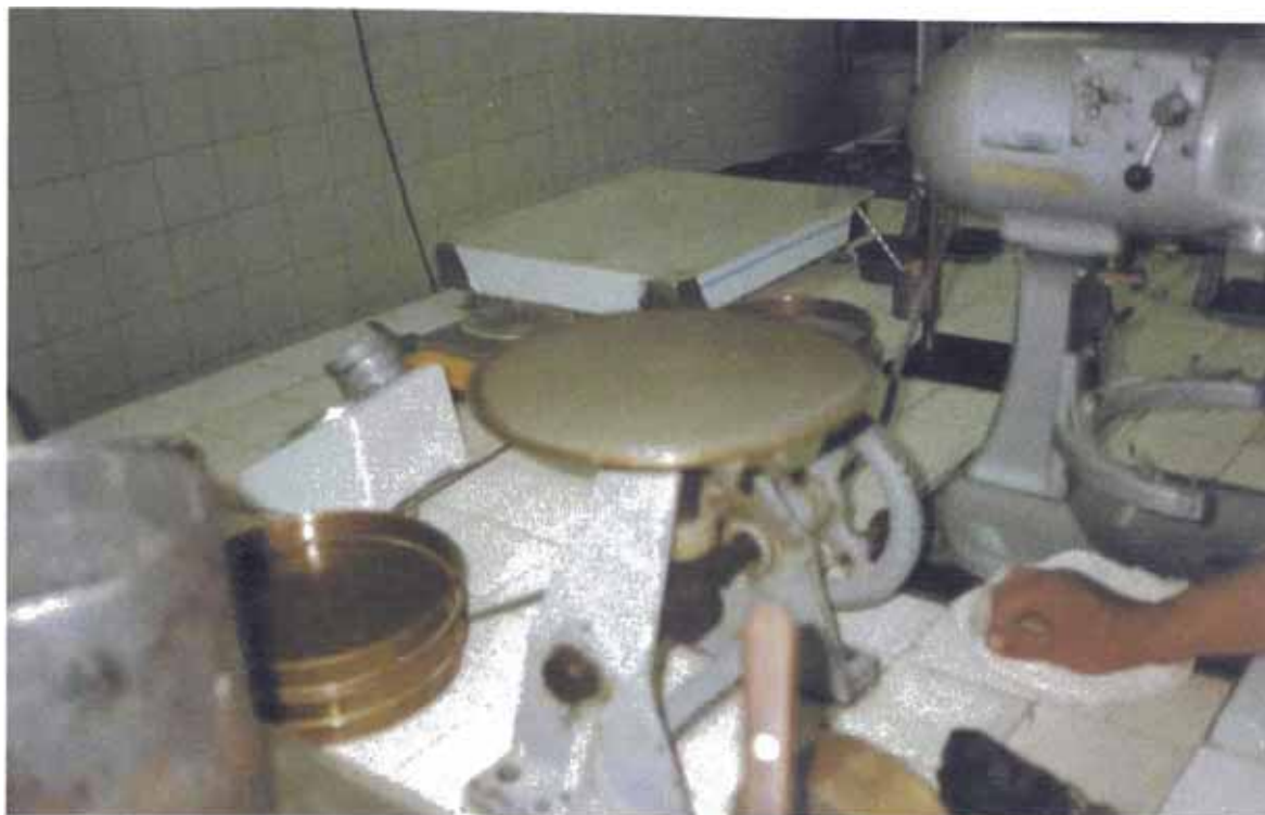
FOTO No 12 ENSAYO DE FLUIDEZ DE MORTERO CON ADITIVO RHEOBUILD 1000
