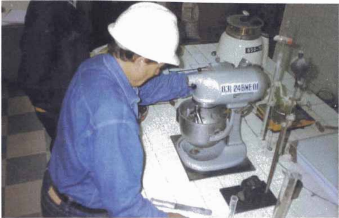
FOTO No 15 PREPARACION DE MORTERO CON CEMENTO PORTLAND TIPO V – ANDINO- Y ADITIVO RHEOBUILD 1000
