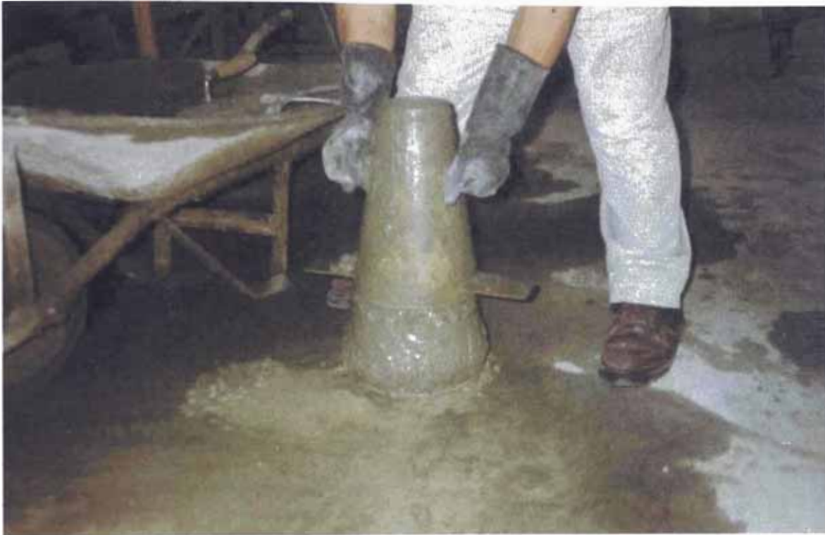
FOTO No 24 ENSAYO DE CONSISTENCIA DEL CONCRETO FRESCO
