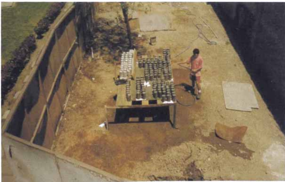
FOTO No 34 CURADO DE PROBETAS DE CONCRETO CON AGUA POR ASPERSION Y CURADO A LA INTEMPERIE
