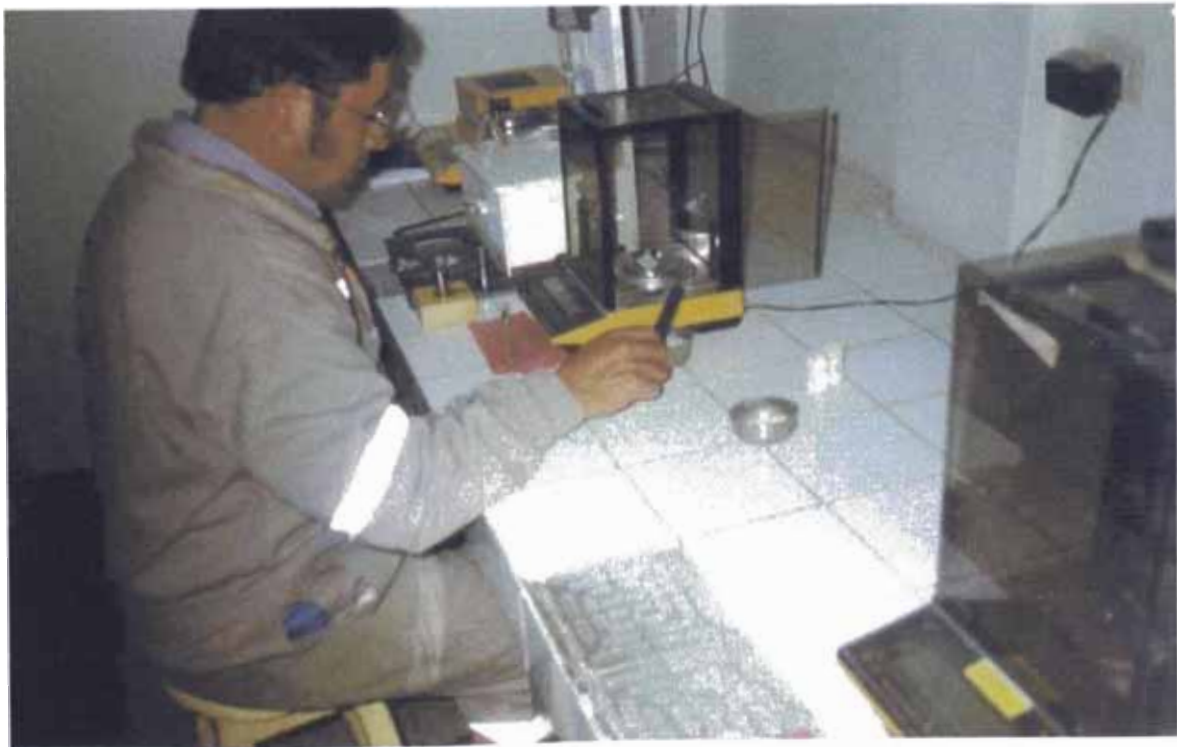
FOTO No 4 PESADO DE LA MUESTRA PARA EL ENSAYO BLAINE EN EL LABORATORIO DE LA FABRICA DE CEMENTO ANDINO
