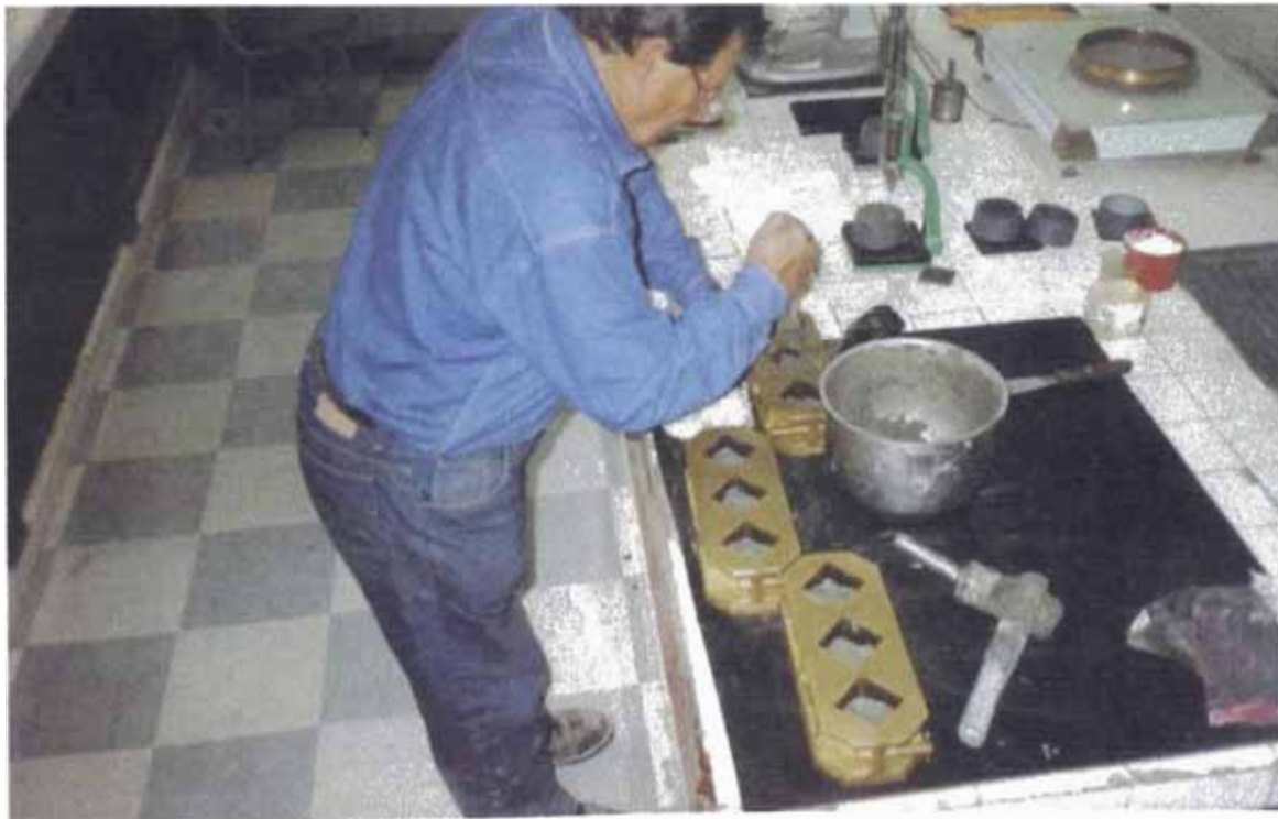
FOTO No16 PREPARACION DE PROBETAS DE MORTERO CON CEMENTO PORTLAND TIPO V – ANDINO Y ADITIVO RHEOBUILD 1000
