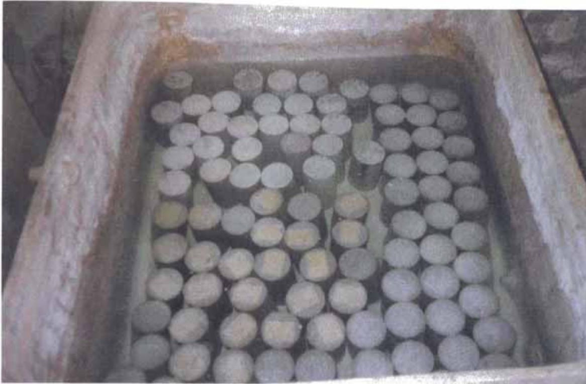
FOTO No 33 CURADO DE PROBETAS DE CONCRETO DE ALTA RESISTENCIA EN LABORATORIO
