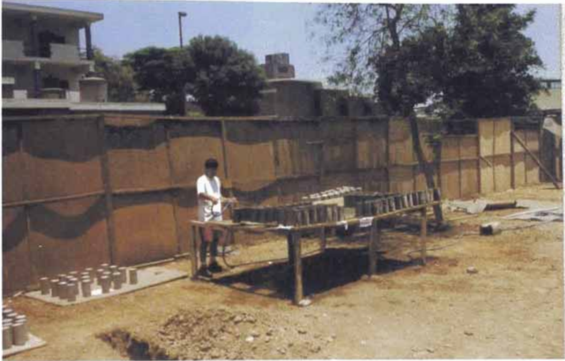
FOTO No 35 CURADO DE PROBETAS DE CONCRETO CON AGUA POR ASPERSION MAS INTEMPERIE
