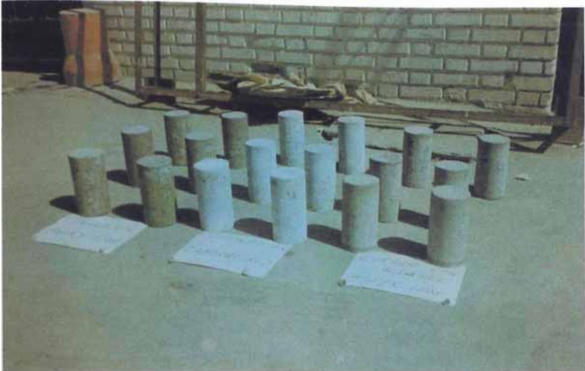
FOTO No 40 PROBETAS PREVIO AL REFRENDADO PARA SU ENSAYO
