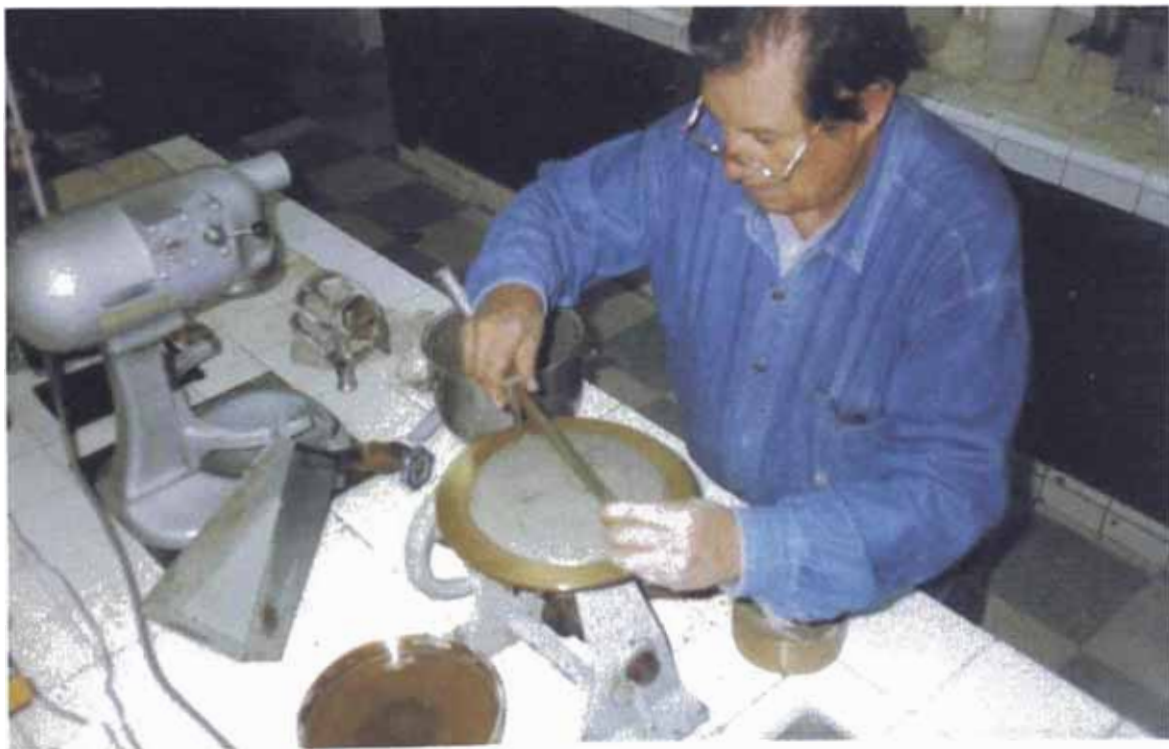
FOTO No 11 TOMA DE MEDIDAS CON EL CALIPERS DEL ENSAYO DE FLUIDEZ
