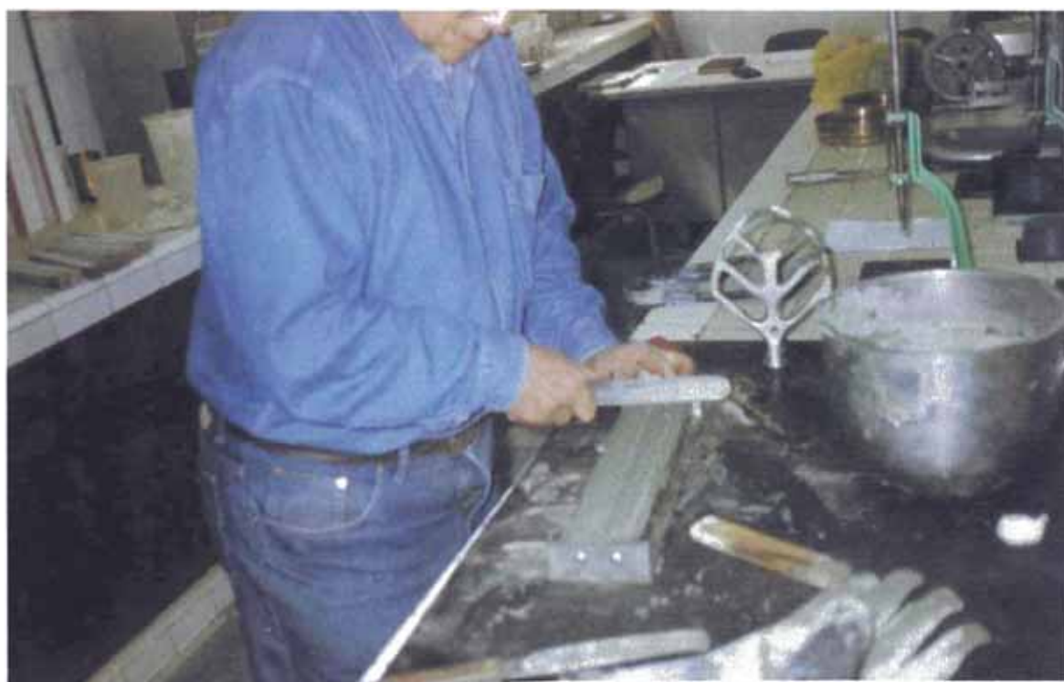
FOTO No 13 ELABORACION DE VIGAS PARA EL ENSAYO DE EXPANCIÓN AUTOCLAVE
