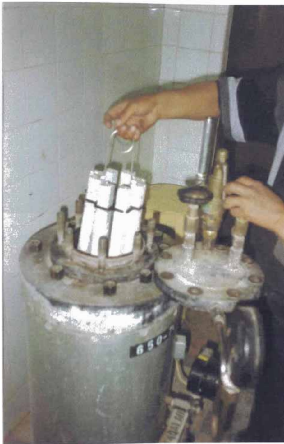
FOTO No 14 ENSAYO DE EXPANSIÓN AUTOCLAVE
