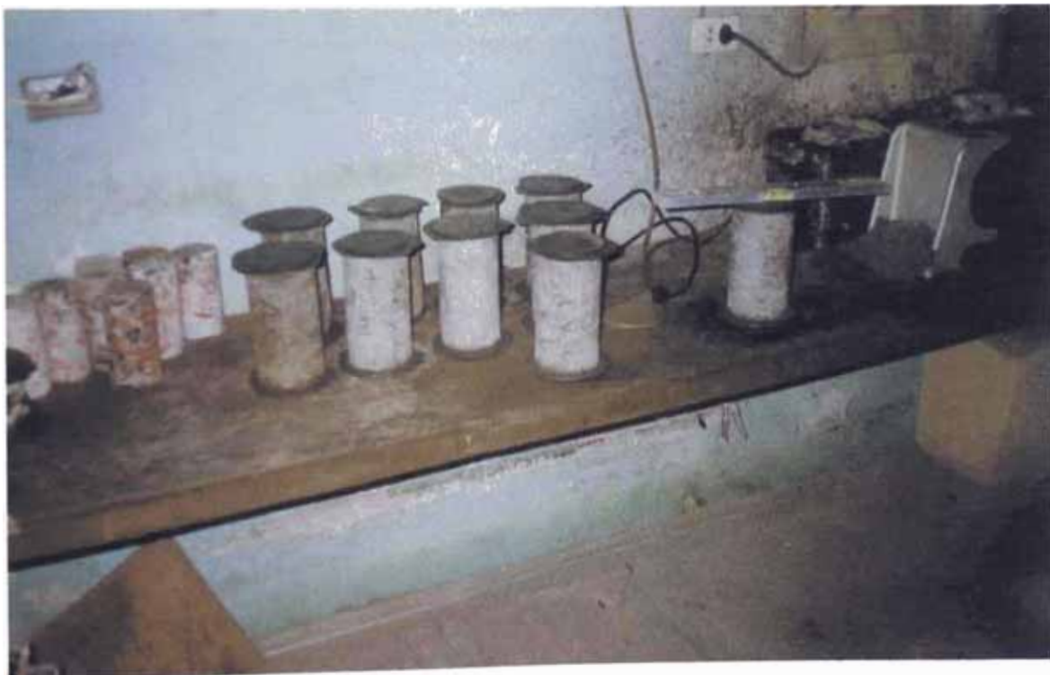
FOTO No 41 REFRENDADO DE PROBETAS DE CONCRETO CON AZUFRE Y BENTONITA
