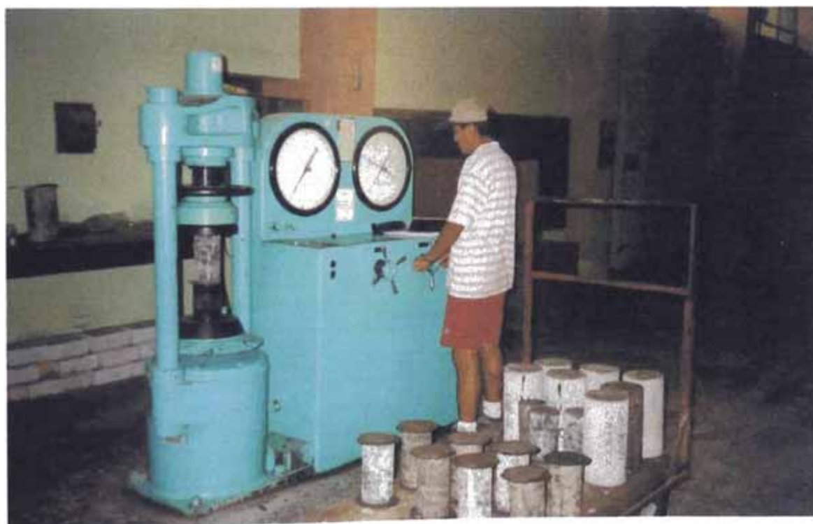
FOTO No 43 ENSAYO A COMPRESION DE PROBETAS DE CONCRETO DE ALTA RESISTENCIA A DIVERSAS EDADES Y PARA CADA TIPO DE CURADO
