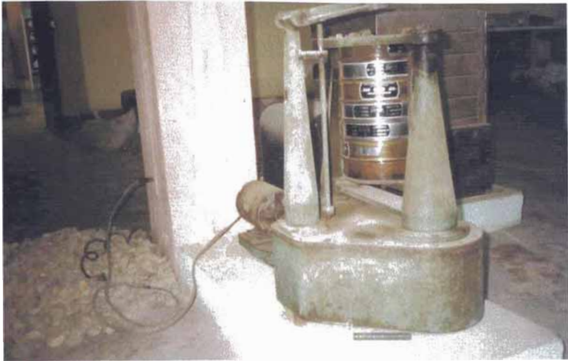
FOTO No 8 TAMIZADO DEL AGREGADO FINO
