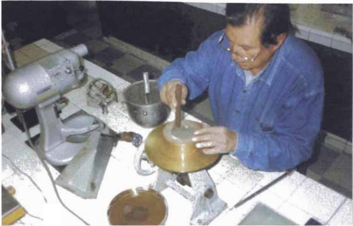
FOTO No 10 ENSAYO DE FLUIDEZ DEL MORTERO CON CEMENTO ANDINO TIPO V
