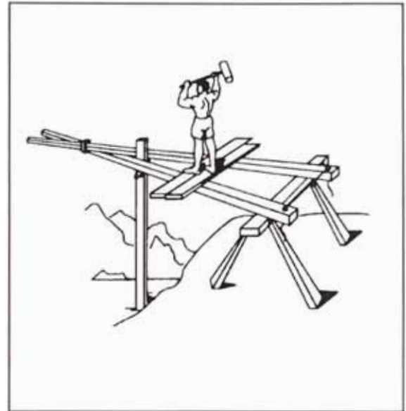
b) Hincado de pilote con mazo
