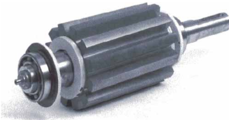
Fig. 2.3 Rotor de un motor de reluctancia conmutado.
