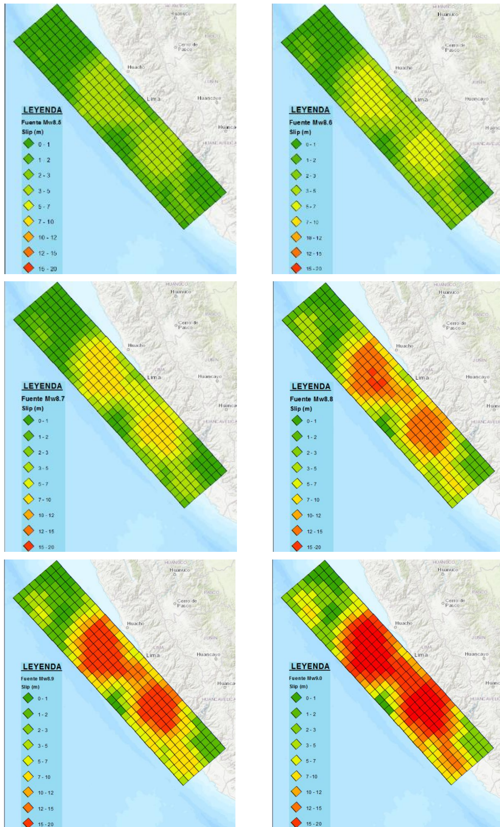
Figura N° 4.7: Distribución de desplazamientos para los escenarios sísmicos de 8.5 a 9.0 Mw (desde la esquina superior izquierda a la esquina inferior derecha). Cada escenario consta de 280 sub fallas cada uno.
