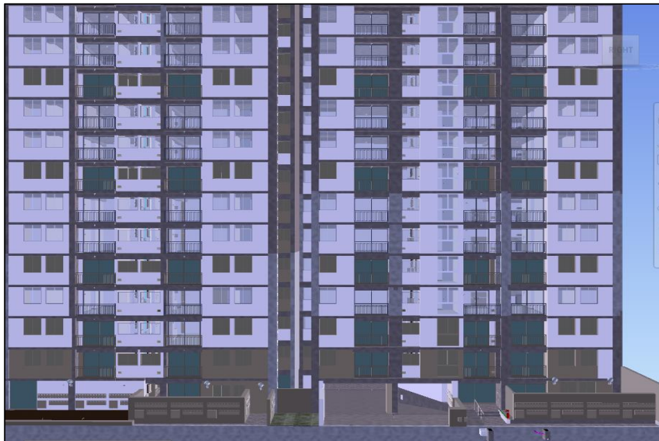
Figura N° 5.2 Terminación de las mamparas en la fachada. Fuente: Modelo Paramétrico Elant
