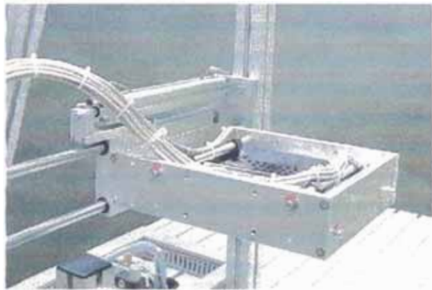
2. Fuente de Luz. La fuente de luz es responsable de suministrar la cantidad de luz requerida para el proceso. Varía según los LED's estén en ON ó OFF.
