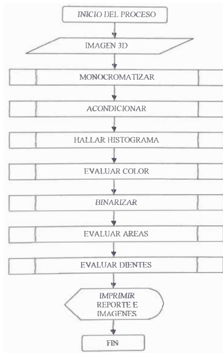
Figura 5.1: Diagrama de flujo del sistema de control de calidad en simulación.
