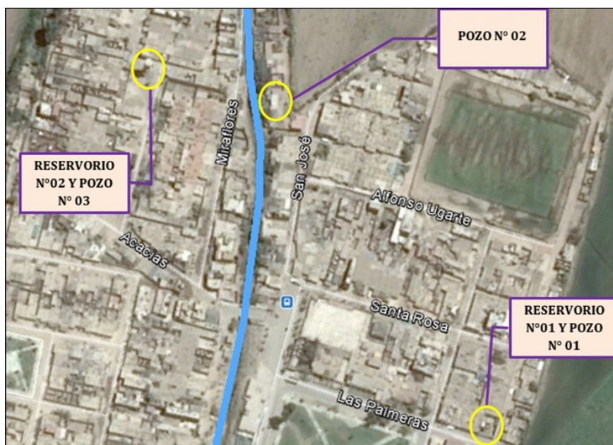
Figura N°6.13 Ubicación de reservorios, Cerro Alegre
