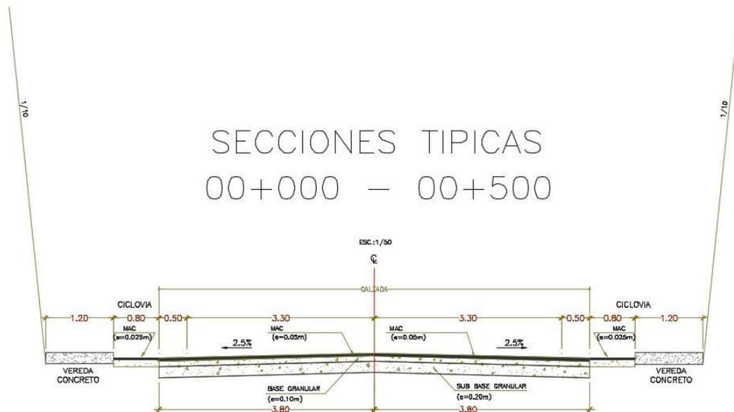
75 Figura 4.14: Sección típica de la vía.
