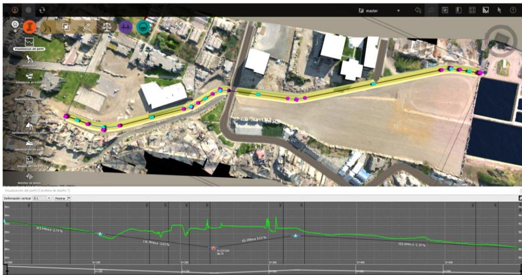
6 Figura 2.3b: Primer trazo preliminar con el Software Infracore - Paso Desnivel UNI-CISMID
