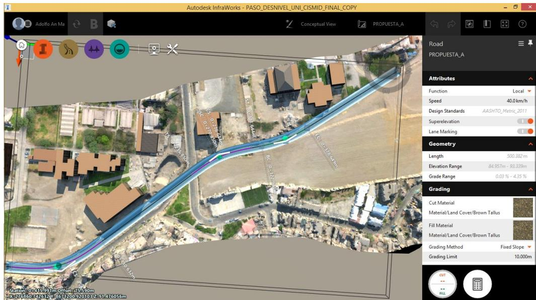
86 Figura 5.4a: Trazo en planta de la propuesta A en el software Infracworks 2020
