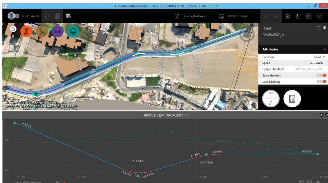
87 Figura 5.4b: Trazo planta y perfil de la propuesta A en el software Infracworks 2020
