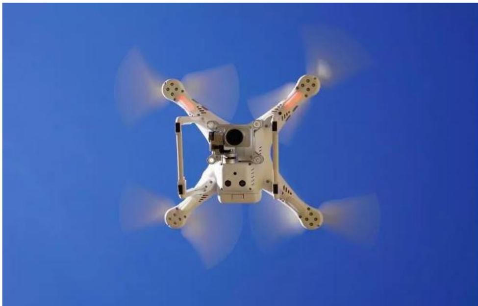
19 Figura 2.12: Cámara fotogramétrica Digital en un Drone.Phantom 3
