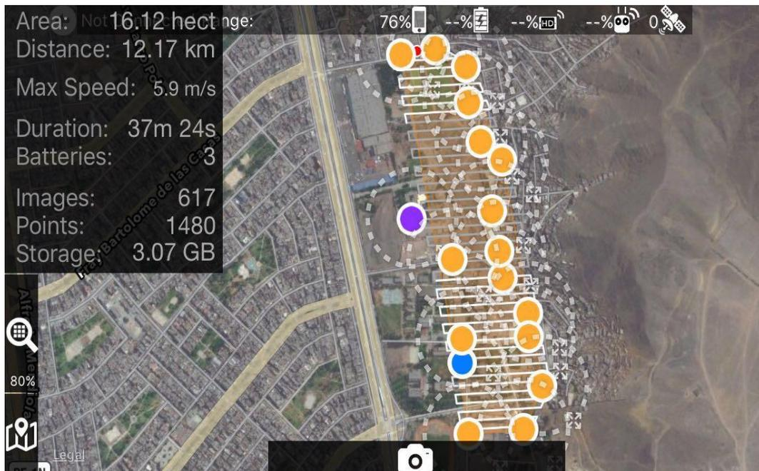
67 Figura 4.9: Plan de vuelo con el software Map Pilot for DJI en el área del Proyecto.
