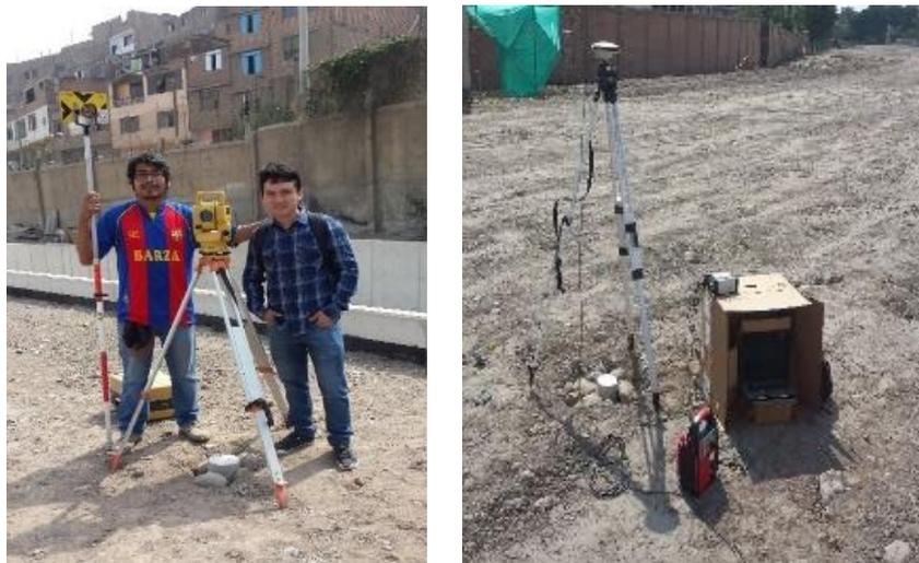
60 Figura 4.3: Equipos estación total (Izquierdo) y GPS diferencial (Derecho).
