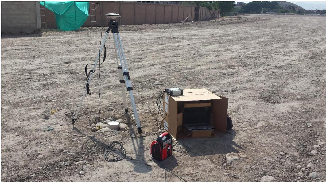
71 Figura 4.11a: Toma de datos mediante GPS Diferencial Pto-05.
