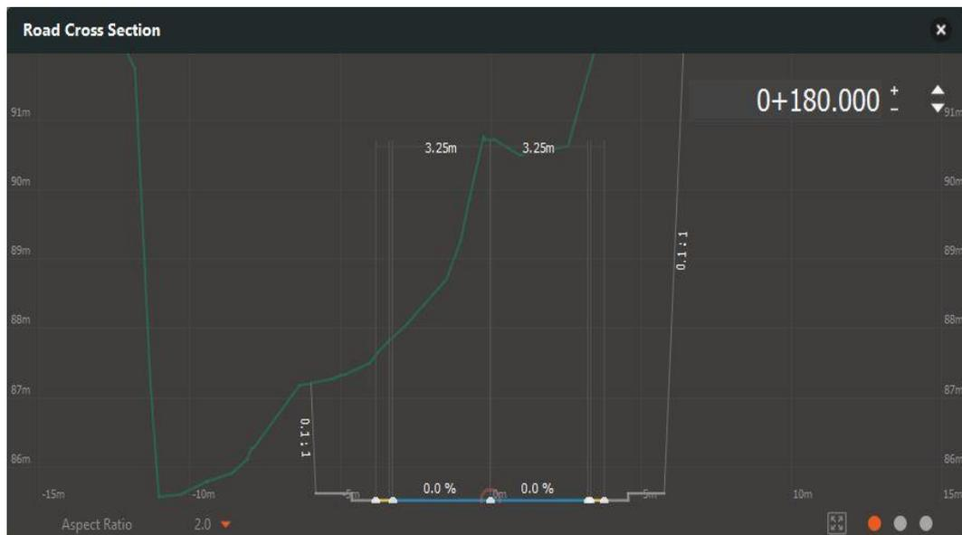
103 Figura 6.8a: Sección de vía en Infracworks 2020
