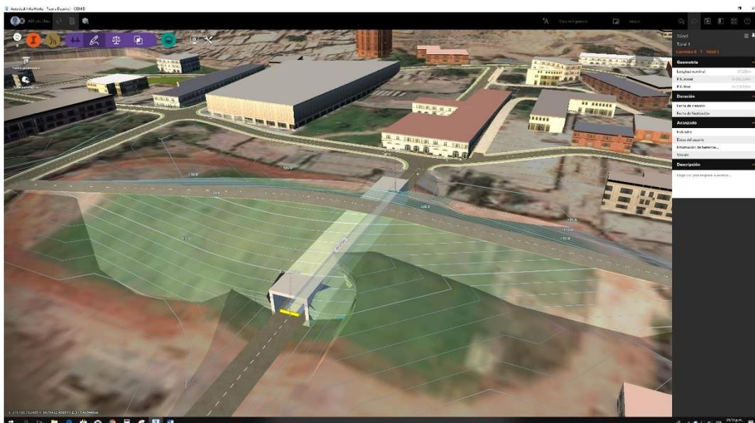
52 Figura 3.17: Definición de la longitud del túnel en un paso de desnivel.
