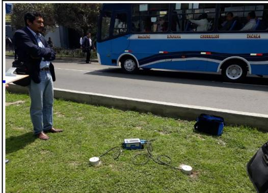
(9) Medición de vibraciones Suelo Exterior al edificio objetivo
