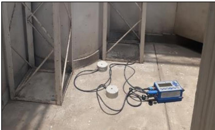
Figura 2.15: Sismógrafo Minimate Pro6
