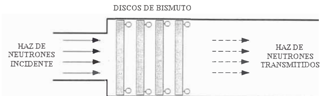
Figura 4.5.- Ubicación del filtro gamma en el conducto externo para la experiencia de atenuación de la radiación gamma.
