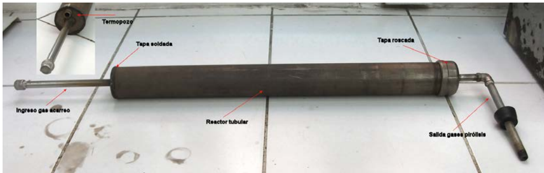
Figura 4.6: Reactor de pirólisis y accesorios
