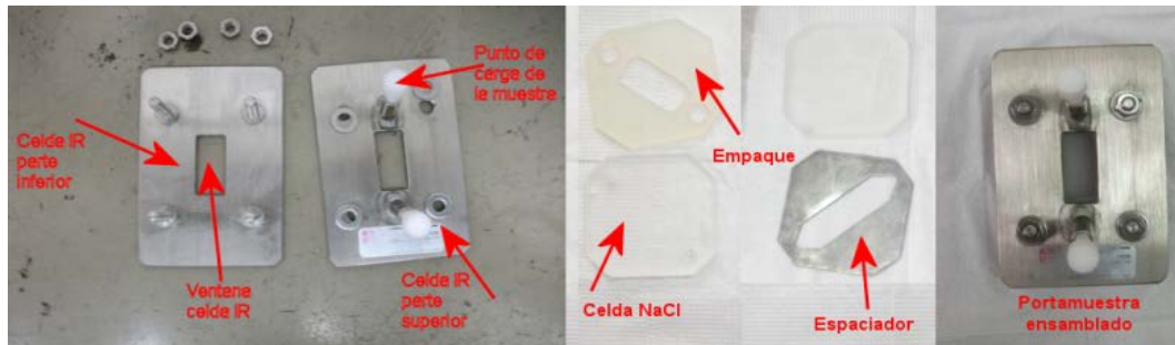
Figura 4.17: Esquema del ensamblaje del portamuestra para el análisis FTIR Fuente: Elaboración propia
