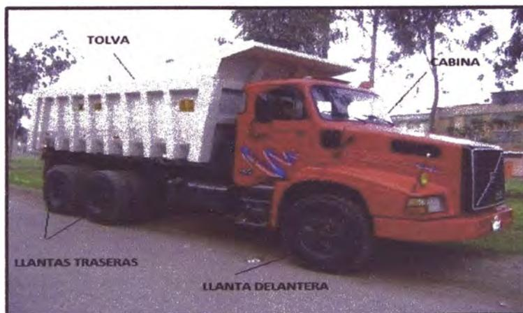
Figura 4.20. Camión Volquete Volvo NL12 (6X4), 54 THCI Potencia 15 M3.
