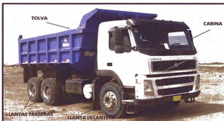
Figura 4.19. Camión Volquete Volvo FM 6X4R, Potencia 440 HP 15 M3.
