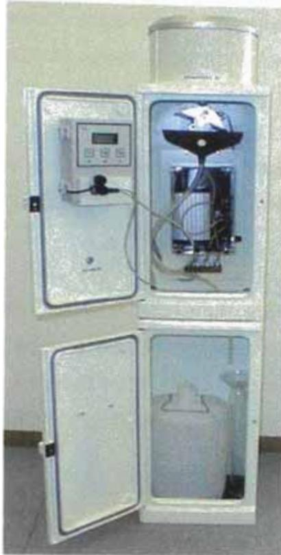
**Figura No.4.2: Detalle del mecanismo interior de un pluviómetro**
