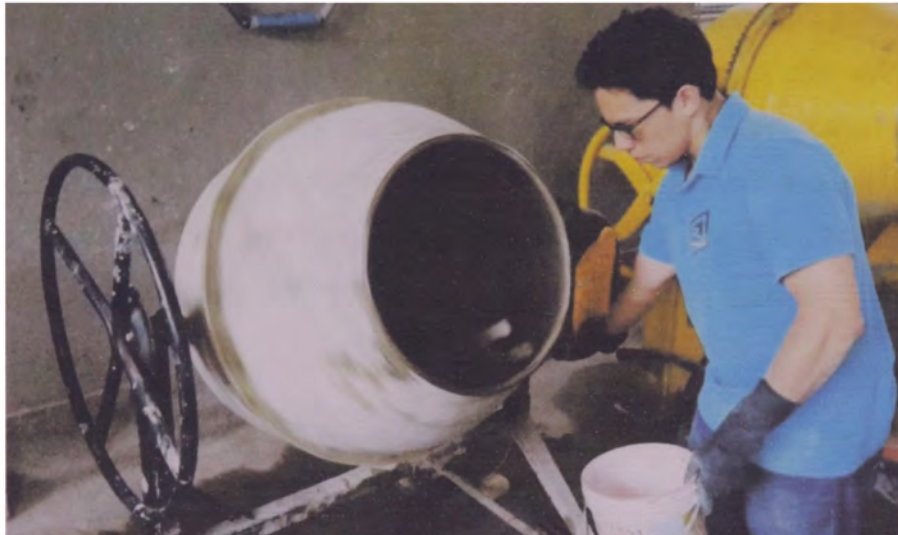
Figura 3.2: Adición de agua a la mezcla durante el proceso de mezclado
