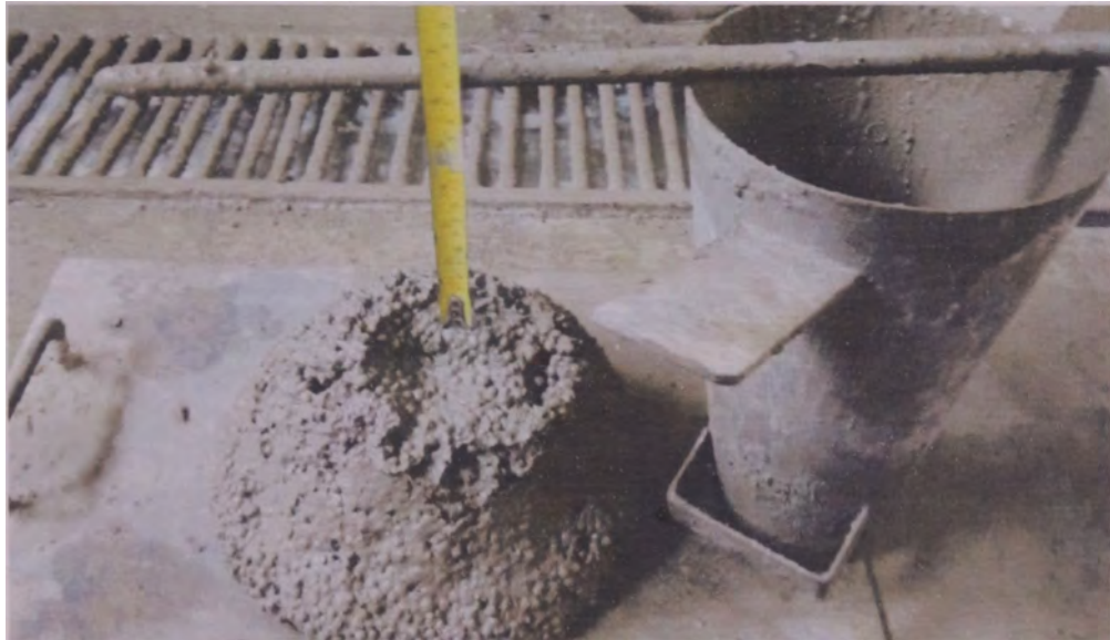
Figura 3.5: Medición del asentamiento mediante el ensayo del Cono de Abrams
