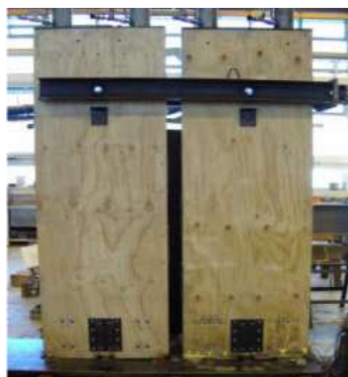
Figura 2 Ensayo de muro autocentrante de madera.
