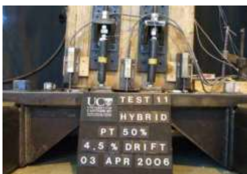
Figura 3 Ensayo en unión columna – base del sistema autocentrante.
