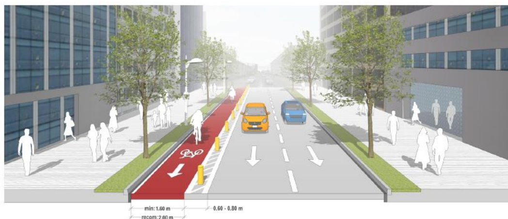
Figura N°34: Esquema de ciclovía unidireccional (Municipalidad de Lima, 2017)
