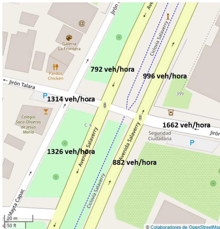
Figura N°80: Punto 5 flujo vehicular medido en campo (Elaboración Propia)
