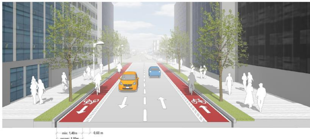
Figura N°35: Esquema de cicocarril (Municipalidad de Lima, 2017)
