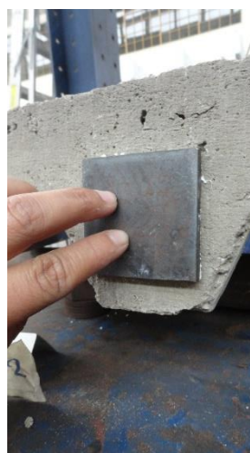
Figura N° 3.24 Fijación de la plancha metálica en la cara lateral de la losa.
