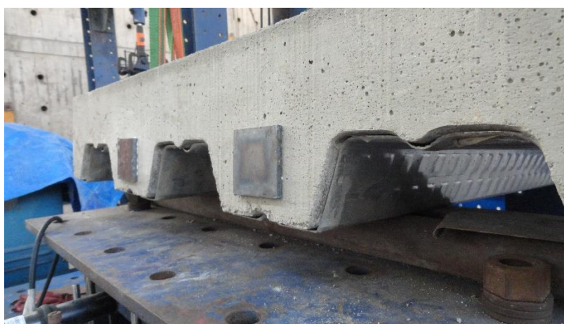
Figura A.9 Disposición de los transductores para medir el desplazamiento relativo en el extremo para el perfil AD-730.
