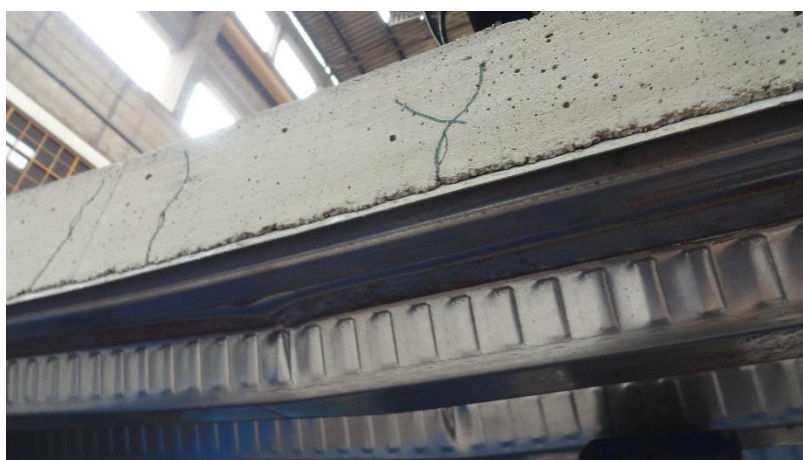
Figura A.6 Estado final de la placa colaborante (AD-600) después del ensayo a flexión.
