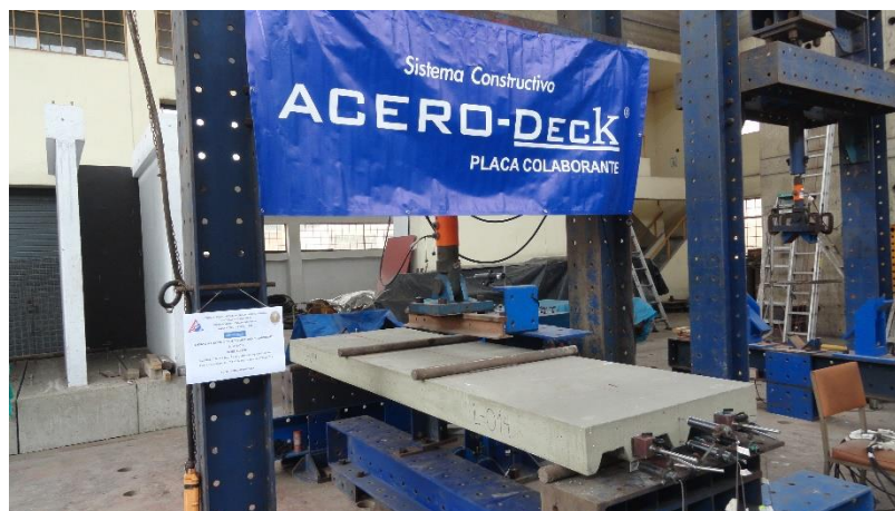
Figura A.7 Estado inicial de la losa L-014.
