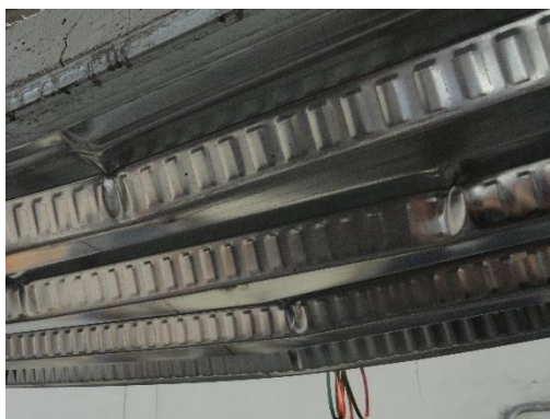
Figura N° 4.36 Pandeo local de las caras laterales de los valles de la placa colaborante.
