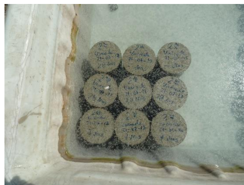
a) Curado de las probetas de concreto.
