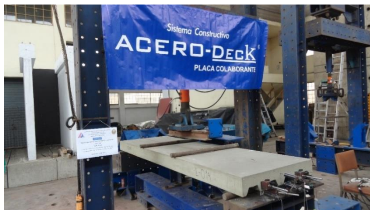
Figura N° 3.1 Ensayo a flexión de losas con placa colaborante.
