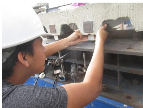
Figura N° 3.26 Fijación de los ángulos de aluminio en la placa colaborante.
