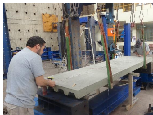
a) Alineación de la losa.
