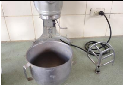
3-Mezclar los agregados, cemento, puzolana y agua
