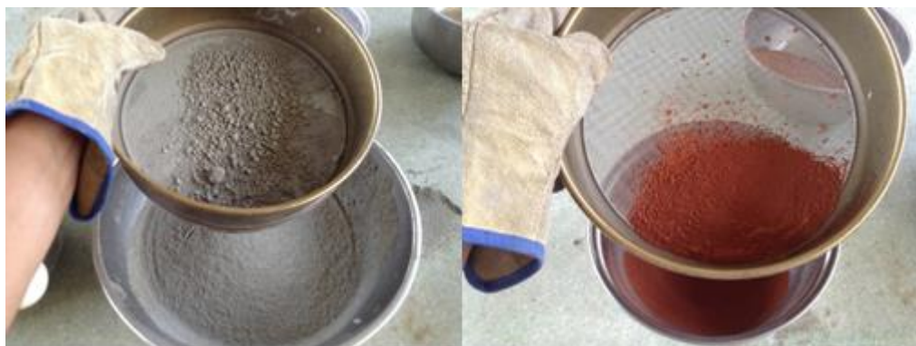
Figura N° 50 Tamizado cemento y puzolana por la malla N°20 (Fuente propia, 2018)
