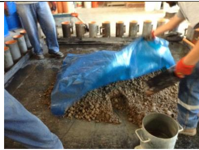
20-Tapar con bolsa plástica para evitar que pierda la humedad
