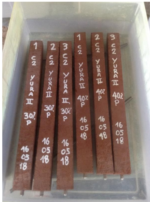
Figura N° 61 Barras de mortero para ensayo reactividad álcali sílice (Elaboración propia, 2018)
