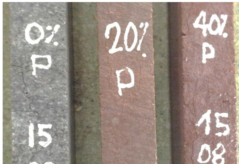
Figura N° 73 Comparación visual de barras luego del ensayo de reactividad. Adiciones de 0%, 20% y 40%. Cantera C1 y cemento tipo I (Elaboración propia, 2018)
