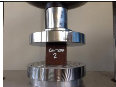
10-Ensayar los cubos en la cara medida
