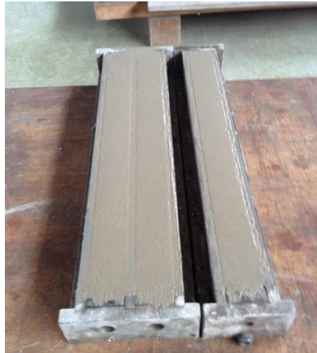
Figura N° 45 Ensayos previos álcali sílice (Fuente propia, 2018)
