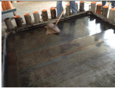
15-Humedecer la plataforma metálica con un trapo
