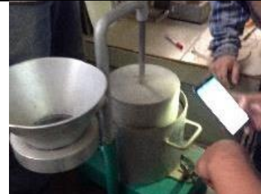
6-Iniciar el ensayo controlando con cronómetro y registrar el tiempo Vebe
