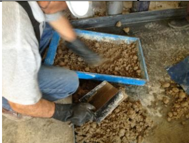
2-Tamizar en húmedo a través de la malla 2"
