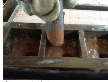
6-Si pasa la fluidez compactar en 2 capas de 32 golpes
