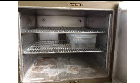
10-Colocar en el horno por 24h a 80°C
