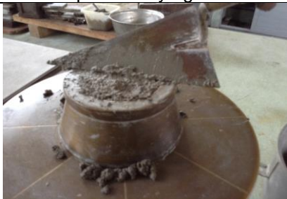
4-Calcular la fluidez según C 1437
