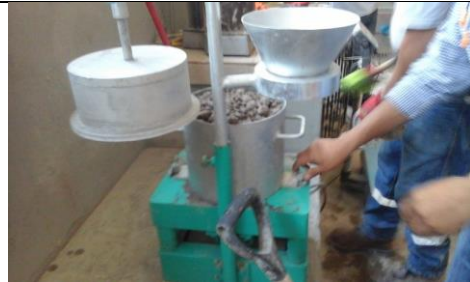
5-Colocar el molde en la mesa Vebe
