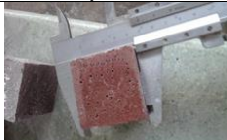
9-Retirar del agua por 15 min y luego medir los lados
