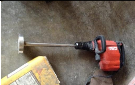
2-Limpiar martillo compactador
