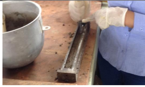
7- Compactar el mortero
