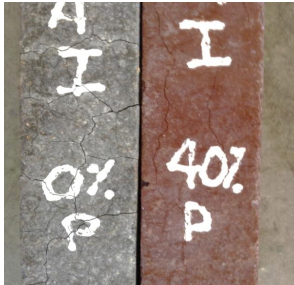
Figura N° 78 Comparación visual de barras luego del ensayo de reactividad. Adiciones de 0% y 40%. Cantera C2 y cemento tipo I (Elaboración propia, 2018)
