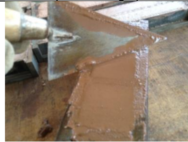
7-Enrasar la superficie del molde
