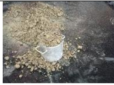
4-Llenar el molde y pesar hasta obtener la cantidad requerida por el ensayo
