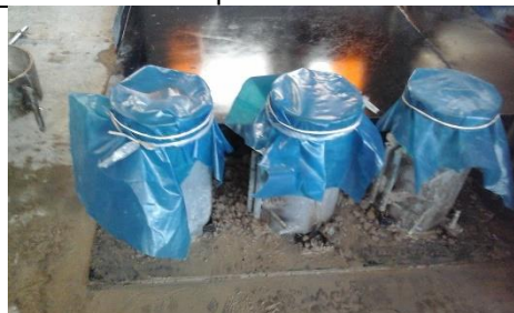
10-Colocar un plástico para evitar la pérdida de la humedad
