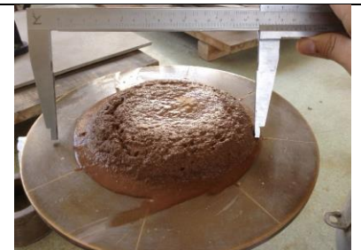
5-Medir diámetro y calcular la fluidez
